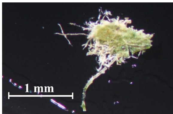
Makrosnímek vzorku barevné vrstvy MV6/10022 (vlevo). Fotografováno na stereomikroskopu SMZ800 (Nikon), bílé dopadající světlo, zvětšení na mikroskopu 20x. Snímek ze skenovacího elektronového mikroskopu Tescan MIRA3 LMU v režimu zpětně odražených elektronů (BSE), HV, 20 kV.
