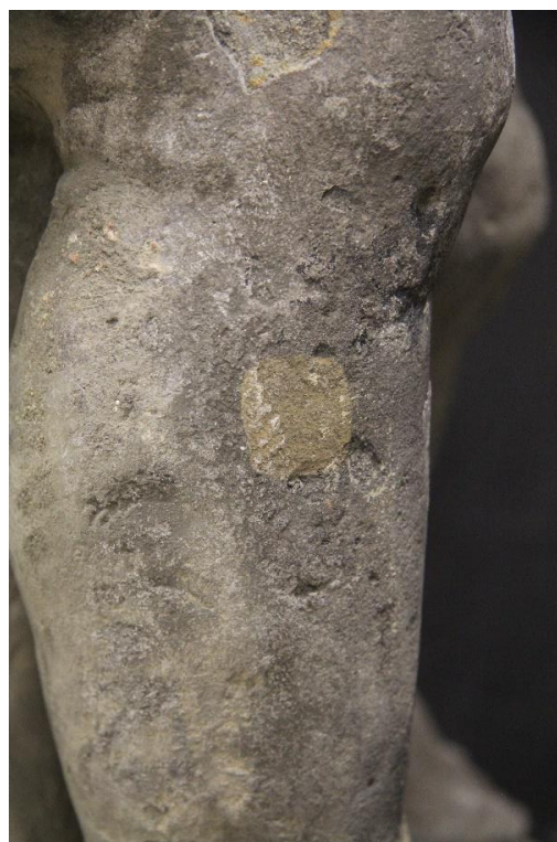
Obr. 53. Zkouška čištění povrchové úpravy laserem
