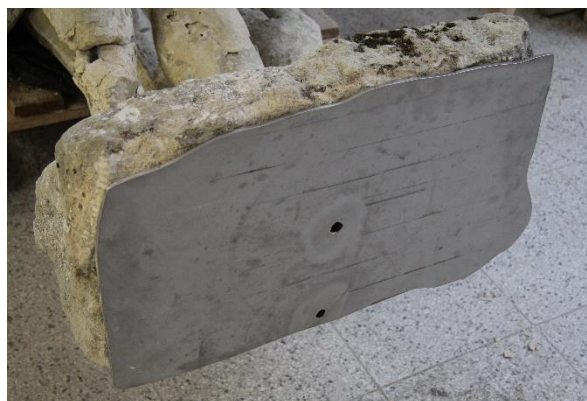
Obr. 79. Nerezová podpůrná deska
