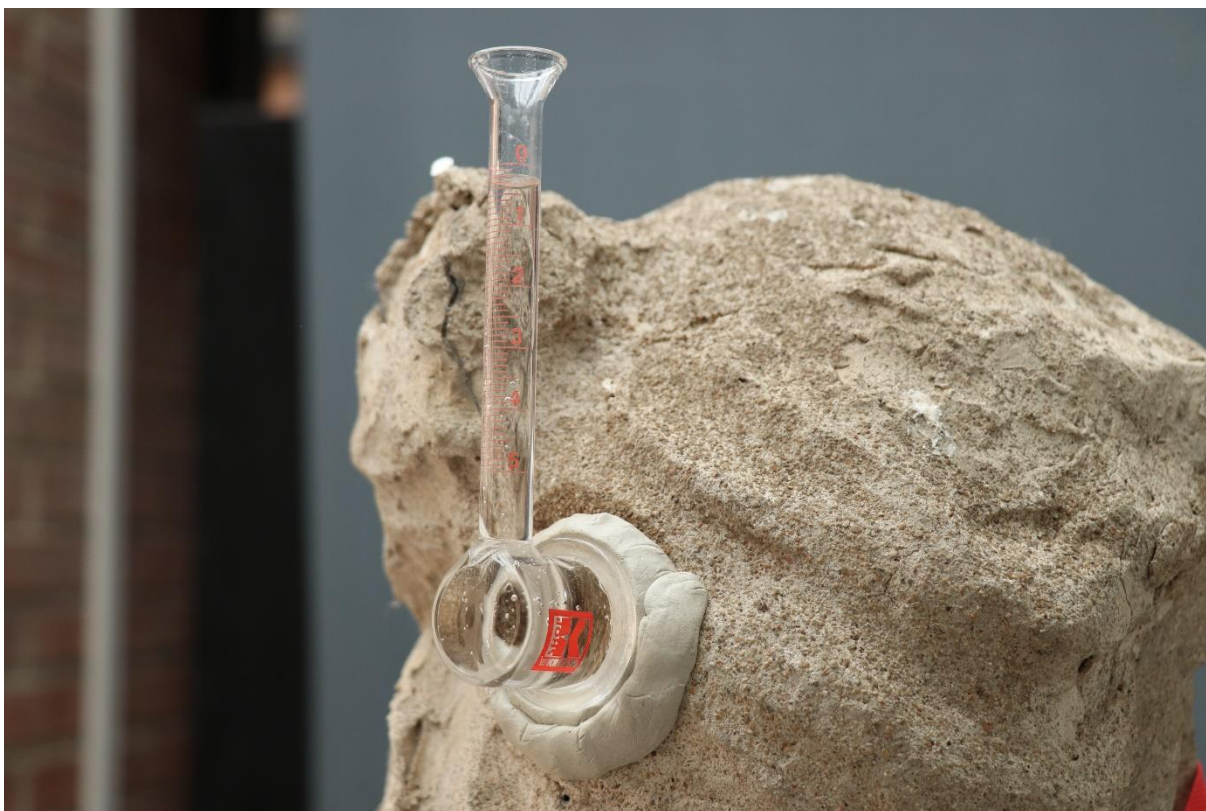
Obr. 35 Měření nasákavosti Karstonovou trubicí
