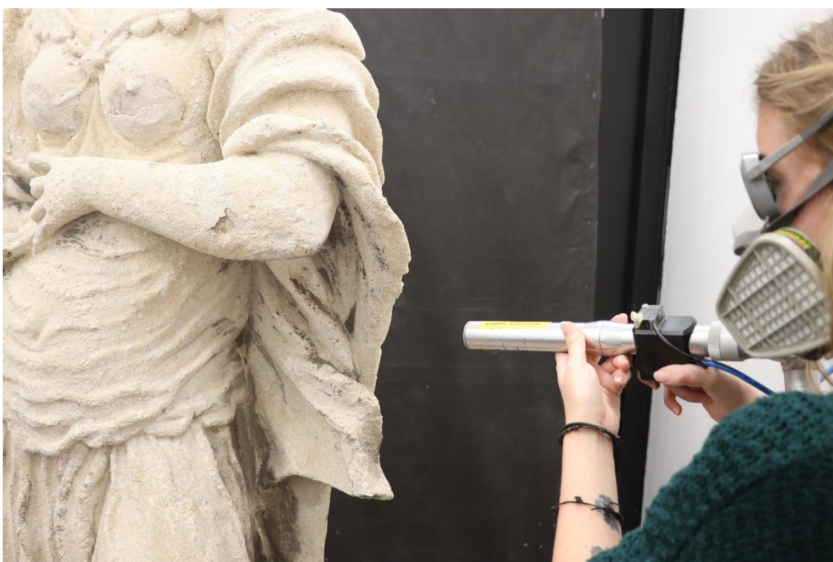
Obr. 37 Čištění sádrovcových krust pomocí laseru
