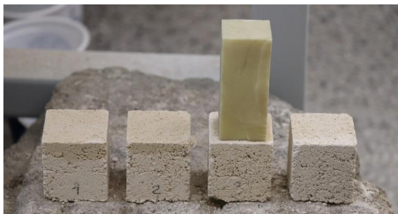
Obr. 13 Měření nasákavosti mikroporézní houbičkou
