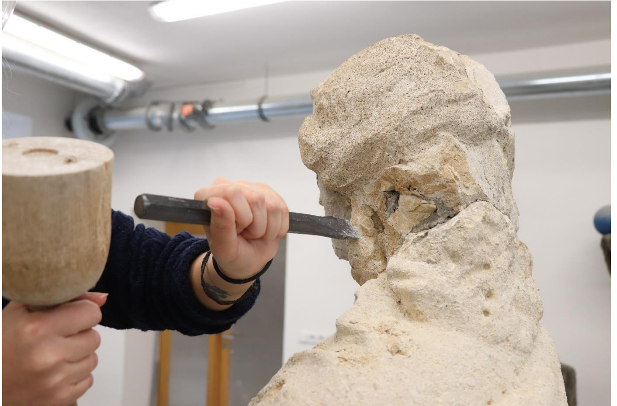
Obr. 40 Odsekávání doplňku hlavy pomocí sochařského dláta
