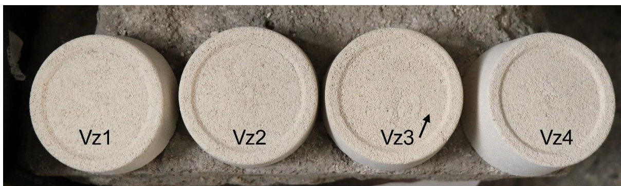
Obr. 12 Vzorčky tmelů na výdusek
