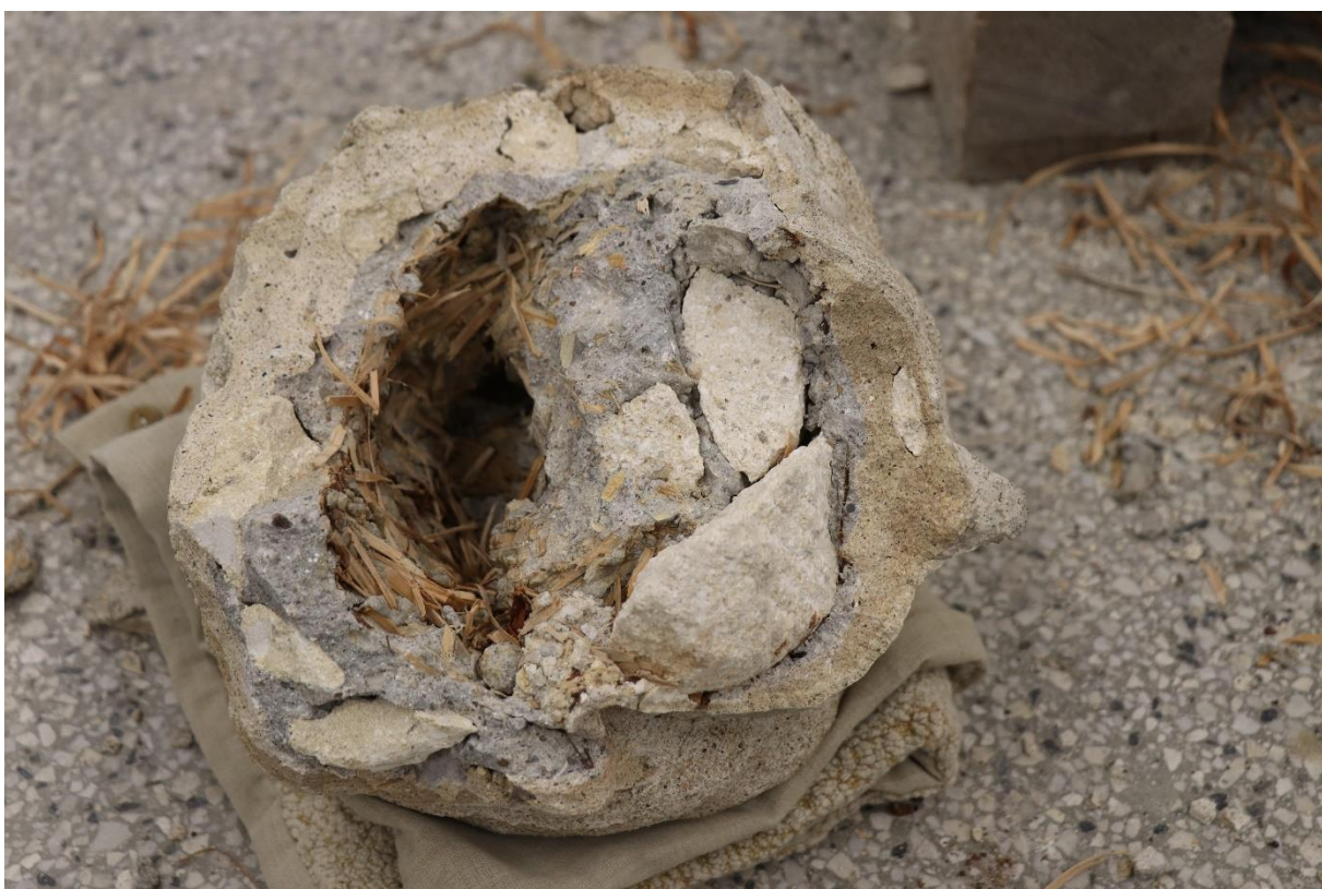
Obr. 43 Pohled na vnitřek doplňku hlavy – viditelná slaměná výplň s úlomky vápence v cementu, na který byl nanesen svrchní tmel
