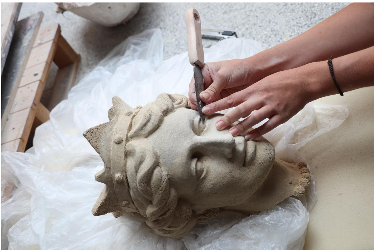
Obr. 62 Strhávání povrchu čersvě vyndané vydusané hlavy
