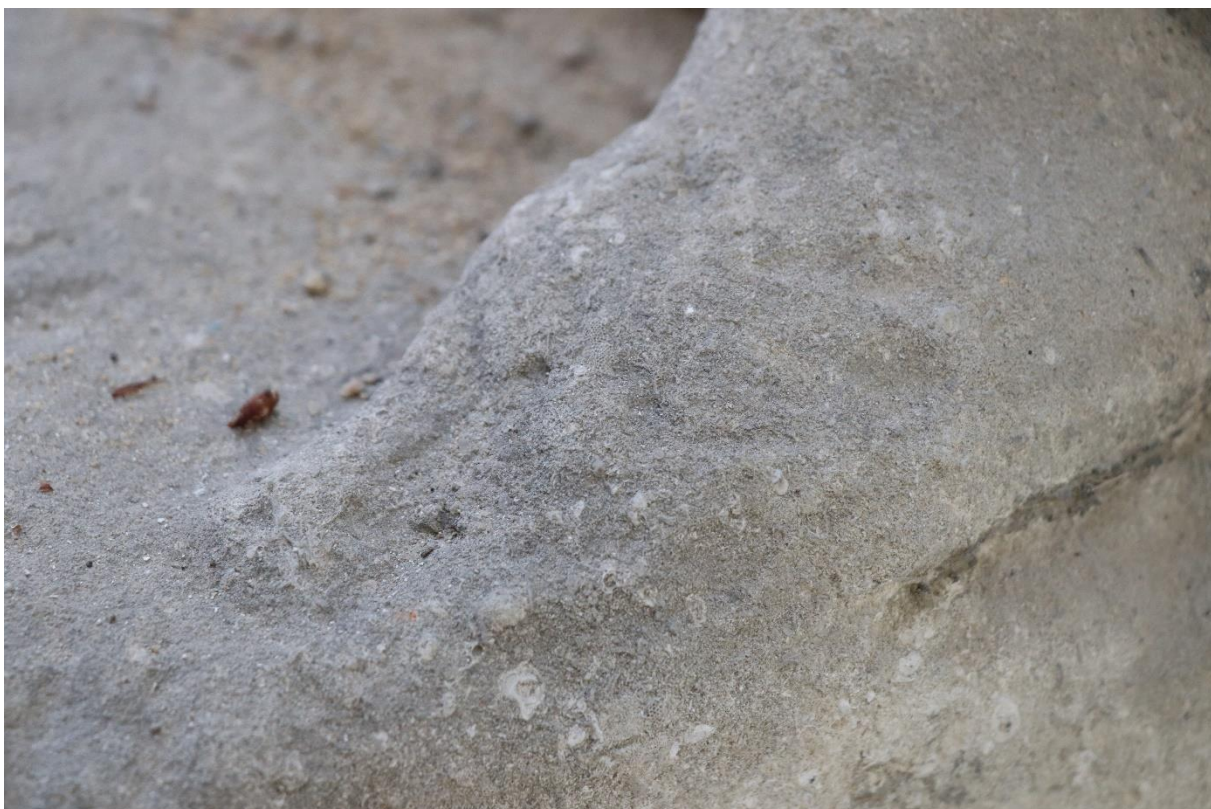
Obr. 26 Detail ztráty modelace prstů u nohy smytím materiálu.
