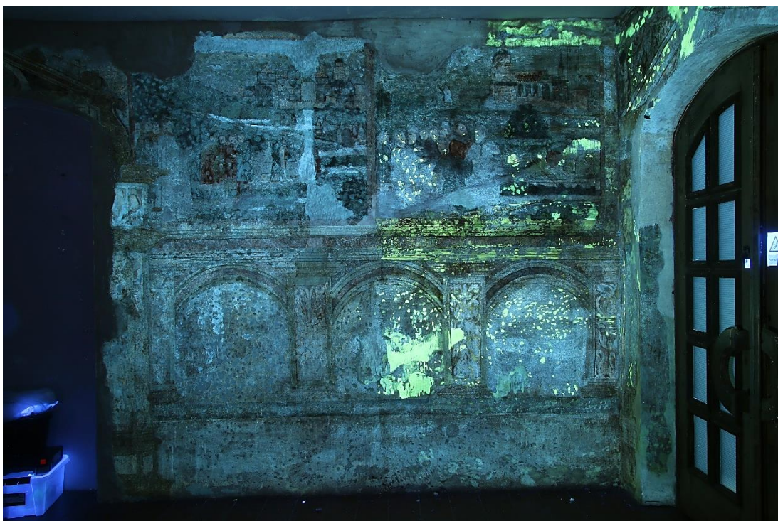
Obr. 36: UV fluorescenční fotografie části západní stěny s restaurovaným výjevem na levé straně. Na fotografii je jasně viditelná rozdílnost předcházejícího restaurátorského zásahu v použitých materiálech. Na sousedním úseku vykazují provedené retuše jasnou žlutozelenou luminiscenci charakteristickou pro zinkovou bělobu, která se na restaurovaném úseku nevyskytuje.
