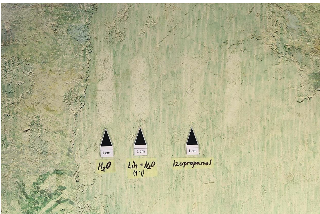
Obr. 34: Zkoušky čištění retuší z předcházejícího restaurátorského zákroku na plošném tmelu.
