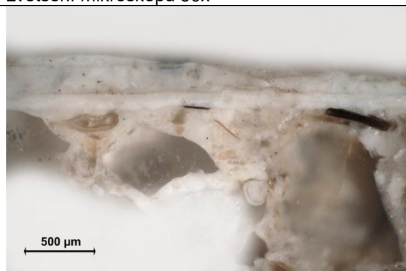
Bílé dopadající světlo, povrch omítky s nátěry, fotografováno při zvětšení mikroskopu 100x
