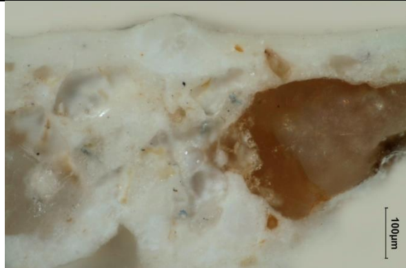
Bílé dopadající světlo, omítka s nátěry, fotografováno při zvětšení mikroskopu 200x
