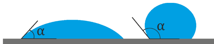
Obrázek 2: Chování kapky kapaliny na hladkém pevném povrchu [5]
