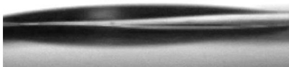
Obrázek 23: Ukázka, jak se kapka kapaliny vlivem deformace upraveného BOPET roztekla
