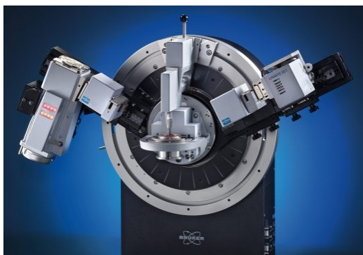
Obr. 12 Brucker AXS D8 Advance a princip vzniku sekundárního záření u XRD [32]
