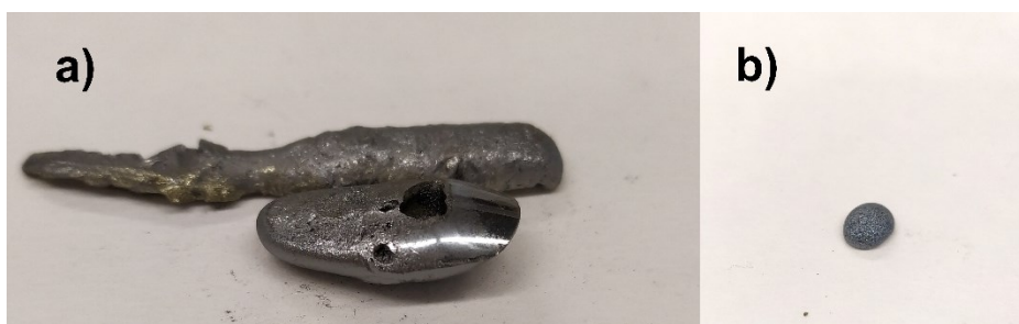
Obr. 19 Ingoty vzniklé při syntéze \text{CuFeS}_{1.92}\text{Sb}_{0.08}
