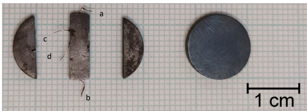
Obr. 18 Tableta po vylisování a očištění (vpravo) a kvádr po měření Hallova napětí s proudovými (a,b) a napěťovými kontakty (c,d)
