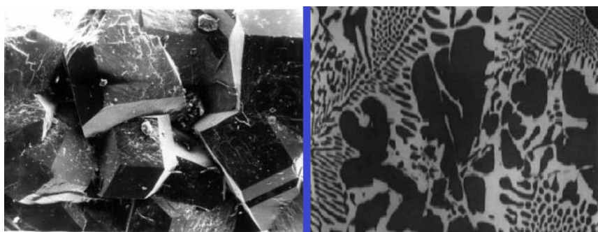
Obrázek 5 - Srovnání analýzy sekundárních elektronů (vlevo) a odražených primárních elektronů (vpravo) stejného vzorku [95]
