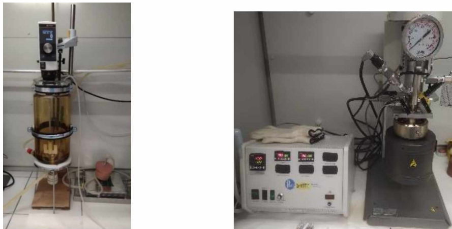
Obrázek 6 - Reaktor pro syntézu hydrotalcitů (vlevo) a reakční aparatura transesterifikace (vpravo)
