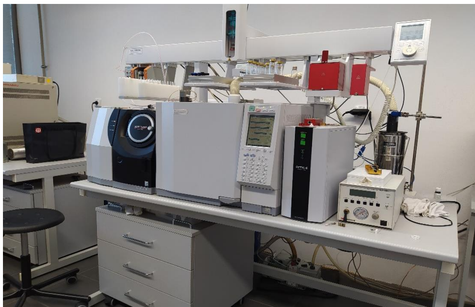
Obrázek 16: Plynový chromatograf GC-2010 s hmotnostním spektrometrem GCMS-TQ8030 a s automatickým dávkovačem AOC-5000
