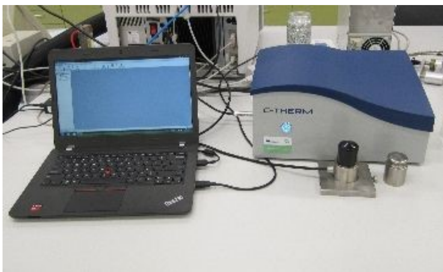
Obrázek 14: Analyzátor tepelné vodivosti – C-Therm technologies, model TCI [29]
