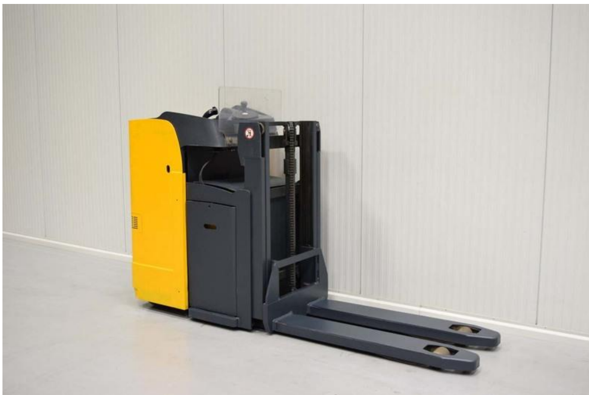
Obrázek 28 Ručně vedený vysokozdvíhací vozík Jungheinrich ESD 120
