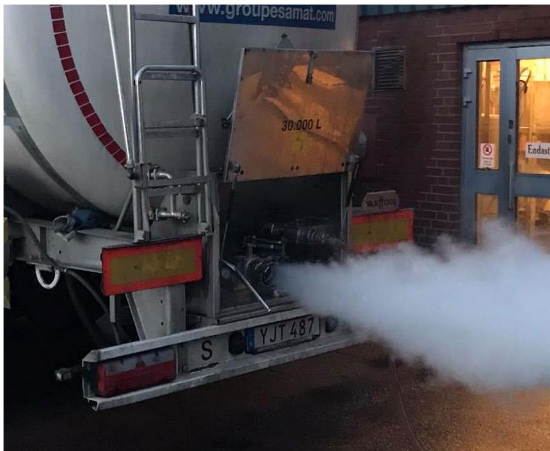
Obr. 19 Napařování cisterny před nakládkou
