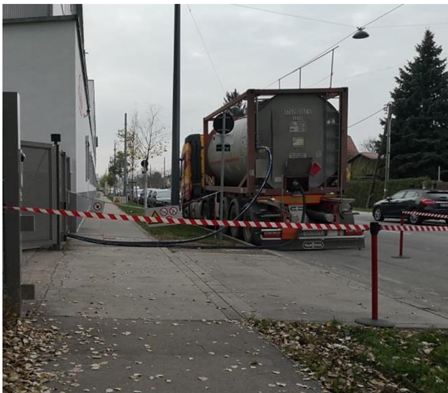
Obr. 14 Vykládka nákladu s vyfotografovanou hadicí rekuperace
