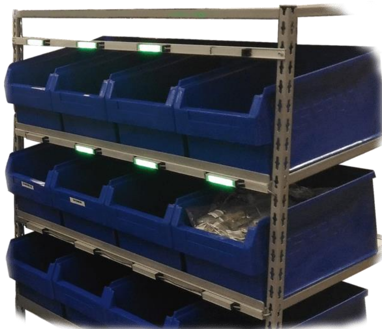
Obrázek 12 Spádový regál spolu se systémem Pick to Light
