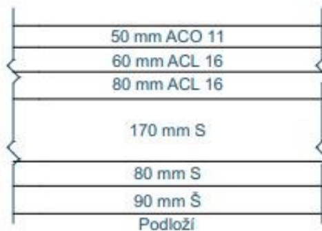
Obrázek 24 Konstrukce vozovky na úseku 1 - Lázně Bohdaneč (1/2)
