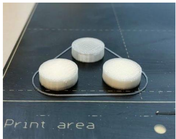
Obrázek 15: Potažené matricové tablety materiálem PVA
