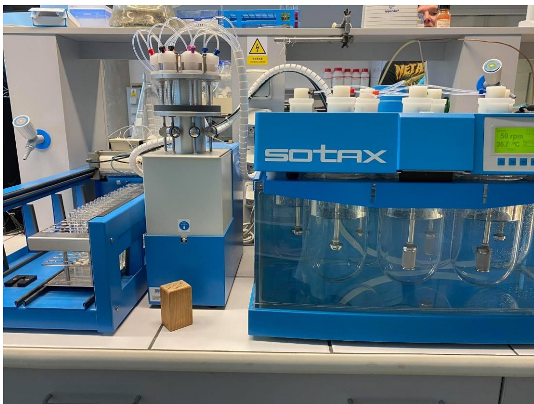
Obrázek 16: Disoluční aparatura SOTAX AT 7 Smart
