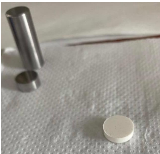
Obrázek 12: Forma pro lisování s vylisovanou matricovou tabletou
