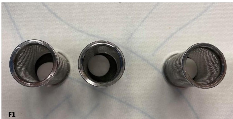
Obrázek 17: Matricové tablety v košíčkách po 18 hodinách disoluce
