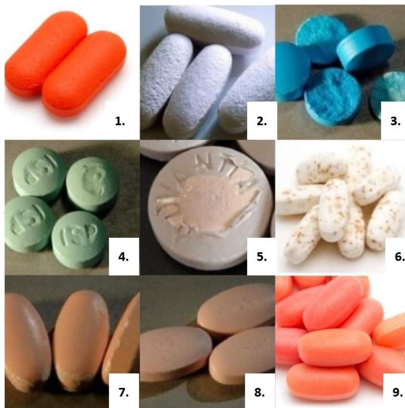
Obrázek 8: Příklady špatného potahování tablet, převzato z: [37]
