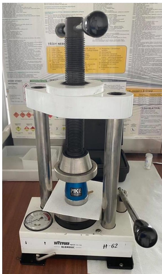
Obrázek 13: Ruční lis s lisovací formou
