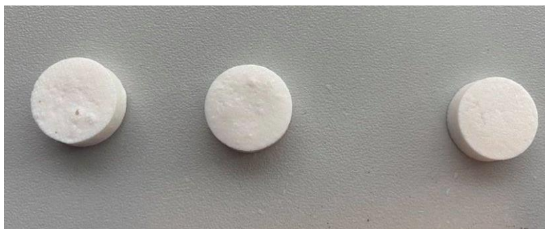
Obrázek 22: Původně potahované matricové tablety po disolučním testování – již bez potahu
