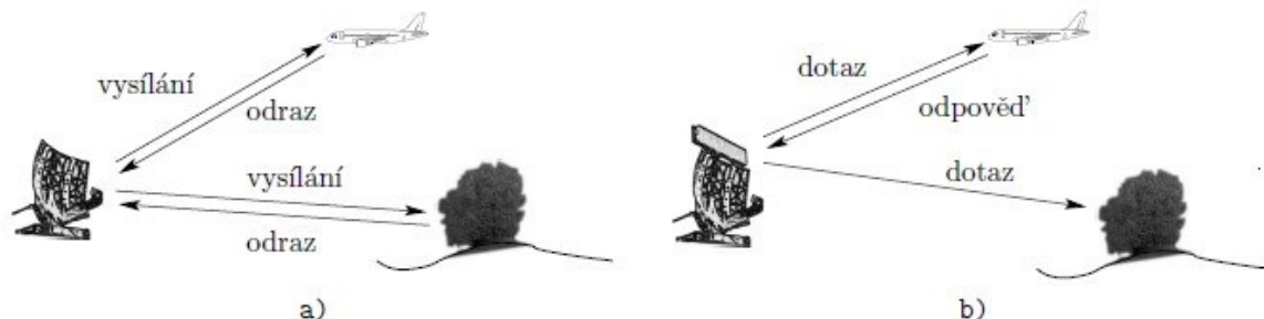
Obrázek 1 - Základní typy radarů, a) primární b) sekundární [1]
