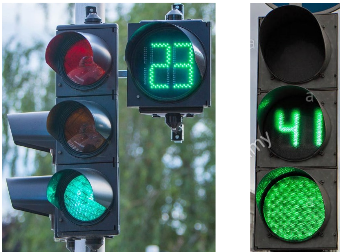
a) Obrázek 3.3 Dopravní semaforey ve světě, a) Semafor s časomírou v Rakousku [22], b) Semafor s časomírou v Rusku [23]
