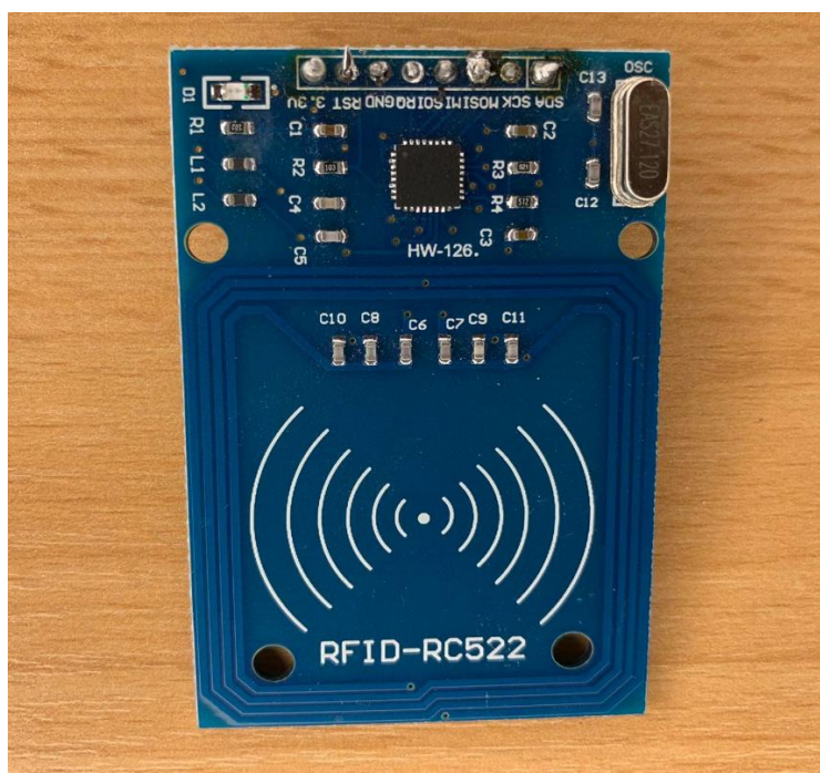
Obrázek 10 Modul RFID čtečka s vestavěnou anténou
