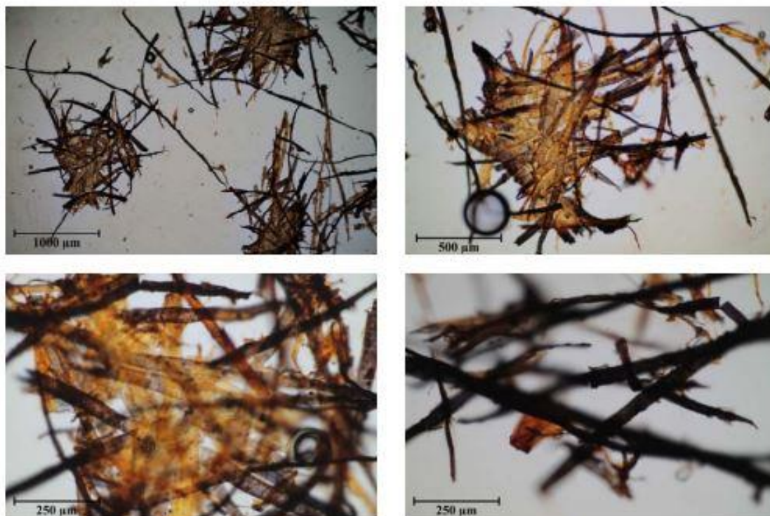
Snímek vláken vzorku 1D/10308 v Herzbergově činidle. Fotografováno na optickém mikroskopu Nikon ECLIPSE LV100 při zvětšení na mikroskopu 50x, 100x a 200x v bílém procházejícím světle.
