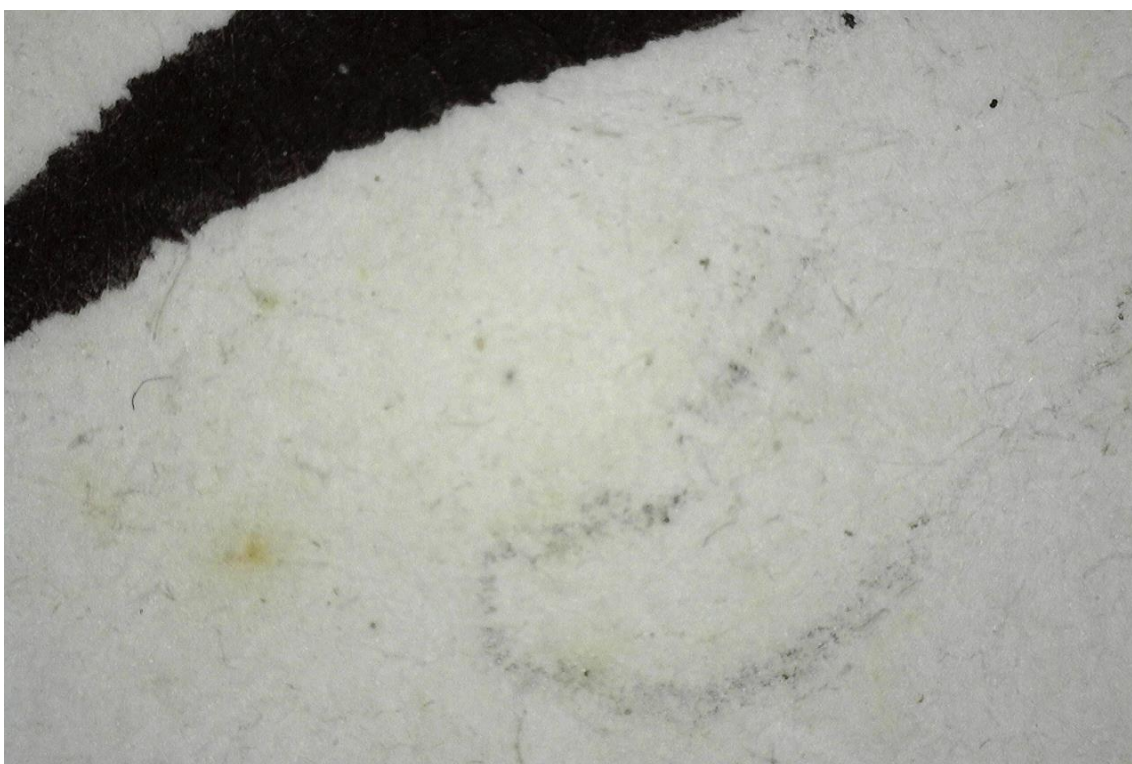
Obr. 121 USB mikroskopie, detail se stopu grafitové tužky
