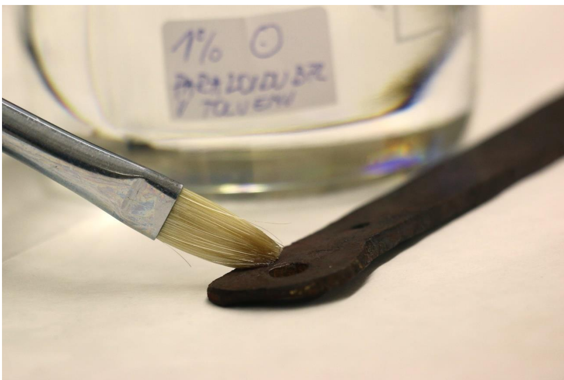
Obr. 141 Konzervace kovových částí nátěrem roztoku Paraloidu B72
