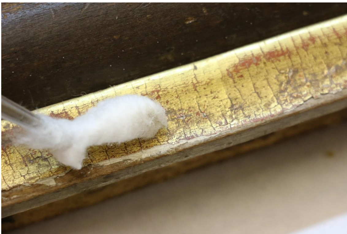
Obr. 102 Čištění zlacených částí rámu acetonem
