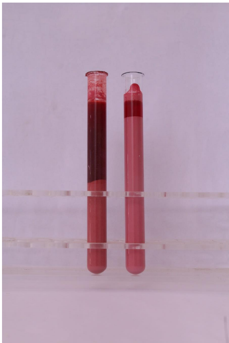
Porovnání obou koncentrací při obarvení barvivem, TER-RAKO injekt , stav po 12 hod.
