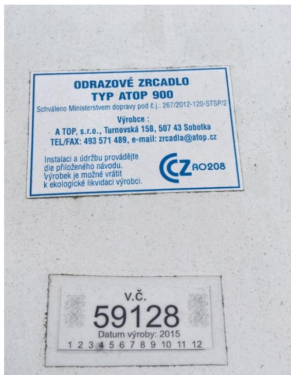
Obrázek 3: Výrobní štítek a štítek montážní organizace označující OZ
