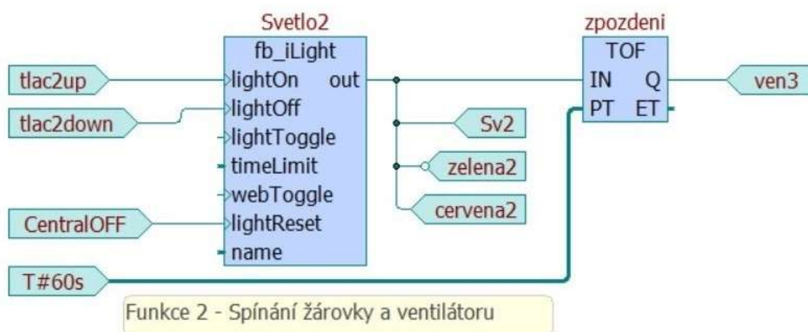
Obr. 5.10 Funkce 2 – Spínání žárovky a ventilátoru
