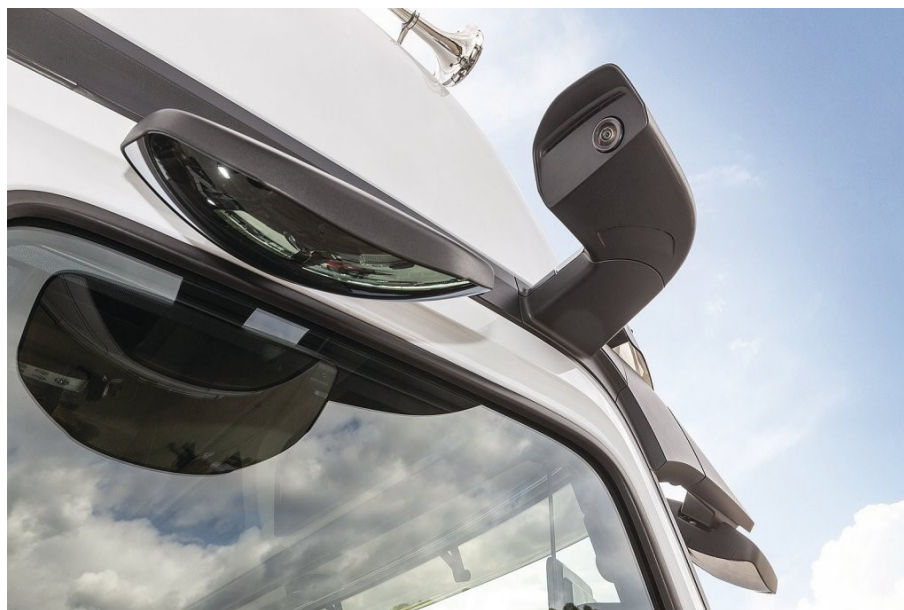
Obr. 24 – Kamera nahrazující boční vnější zrcátka 97
