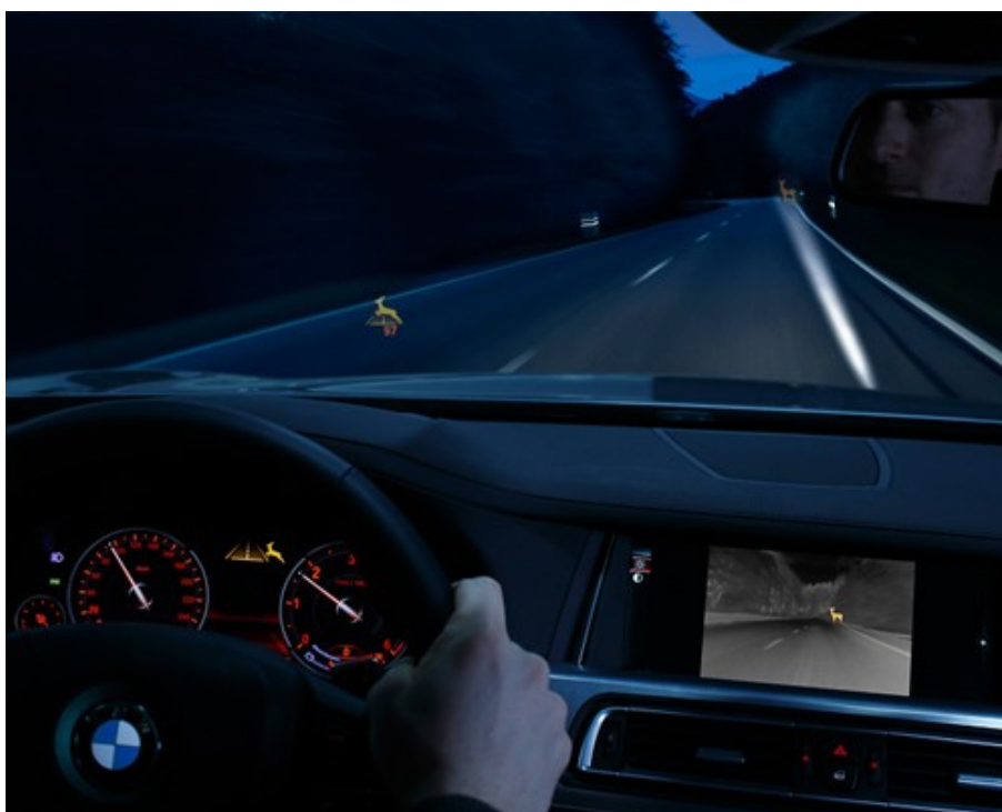
Obr. 17 – BMW Night Vision se systémem Dynamic Light Spot 72
