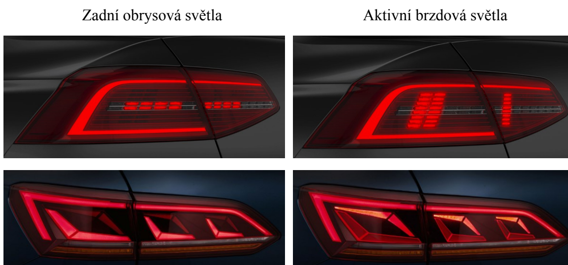
Obrázek 7: Změna grafiky zadního osvětlení od výrobce Volkswagen [10]
