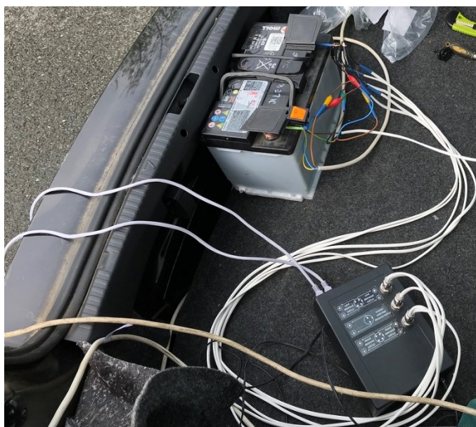
Obrázek 14: Zapojení měřicí soustavy – vozidlo vysílající optické podněty
