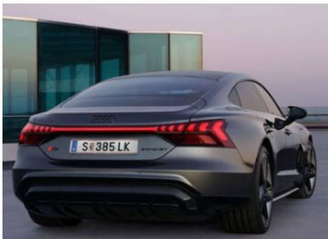
Obrázek 6: Zadní průběžná obrysová světlík Audi RS e-tron GT [9]
