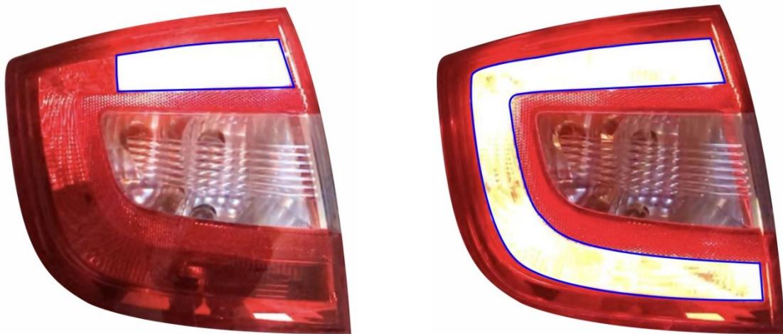
Obrázek 16: Standardní plocha a Zvětšená plocha brzdových světel
