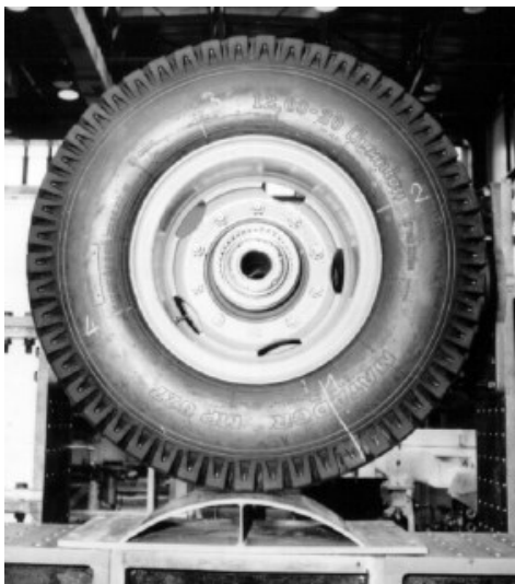
Obrázek 9: Radiální deformační charakteristika pneumatiky na vypuklé podložce [8]
