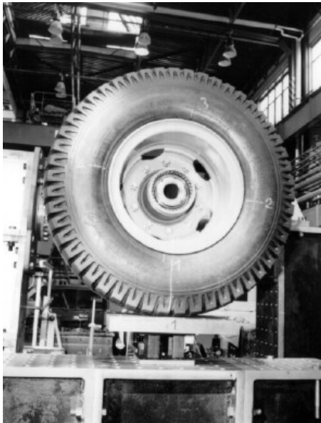
Obrázek 8: Radiální deformační charakteristika pneumatiky na rovné podložce [8]
