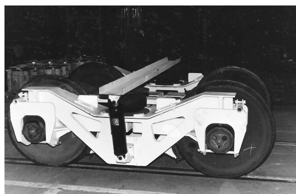
Obr. 1.5 – Příklad pryžového vypružení u amerického podvozku [14, s. 36]
