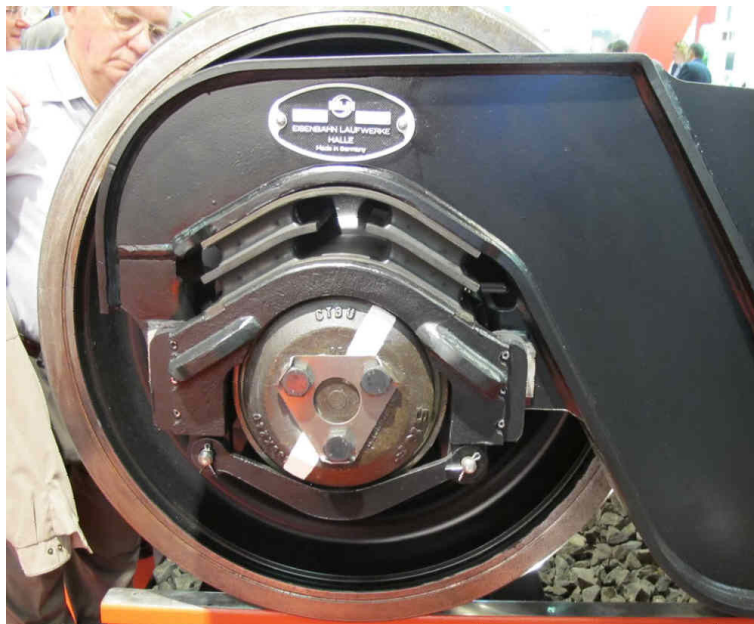
Obr. 1.6 – Primární vypružení podvozku RC25NT ; upraveno [18]
