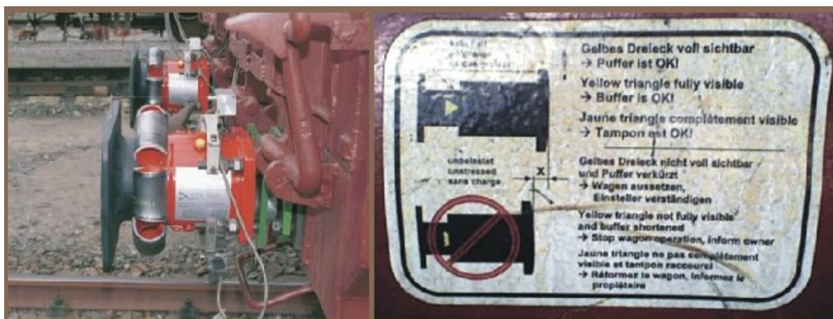
Obr. 17 – Poškozený „crashový“ nárazník. Zdroj: [5]
