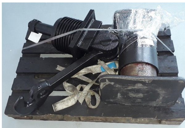
Obr. 27 – Nárazník a vypružení tažného ústrojí 1 (pryžo-kovová pružina), Krnovské opravy a strojírny s.r.o. Snímek: Jakub Vágner
