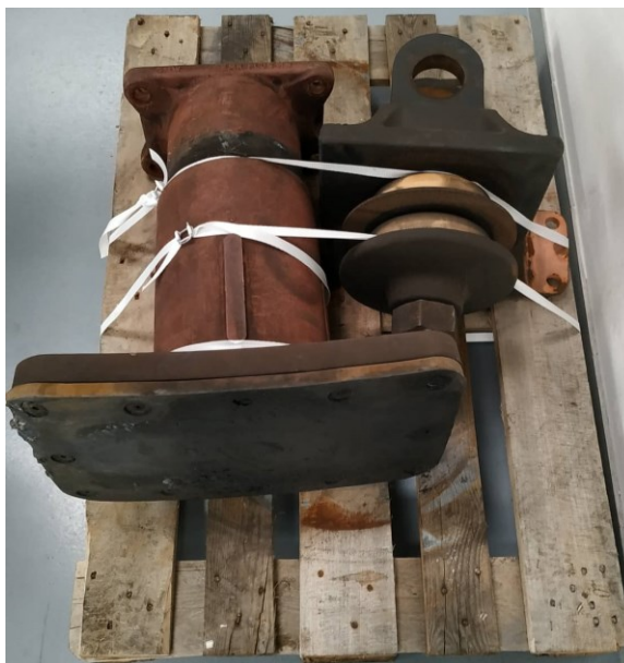
Obr. 28 – Nárazník a vypružení tažného ústrojí 2 (elastomerové bloky), Metrans. Snímek: Jiří Šlapák
