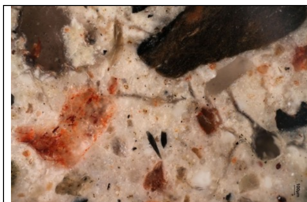
Nábrus (O3A), mikrofoto v bílém odraženém světle, nábrus, fotografováno při zvětšení 20x, horní omítková vrstva
