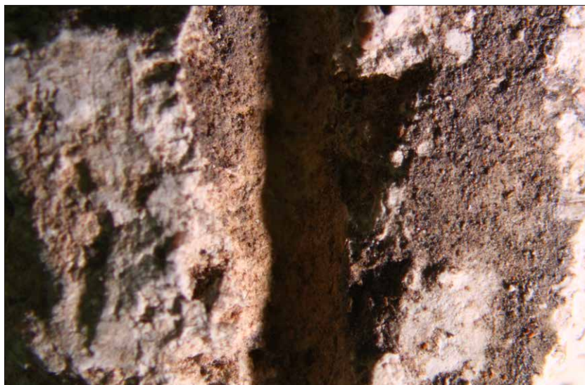
Obr. 221 Detail rytí renesančních sgrafit v bočním nasvícení pod stereomikroskopem na vzorku NV2 odebraném na půdě Piccolominsko Kuronského traktu SZ Náchod.
