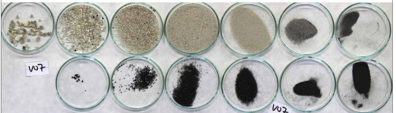
Vzorek VO7 (1974) rozdělený síťovou analýzou. Objemový poměr plniva je cca 11 písku : 1 uhlí.
