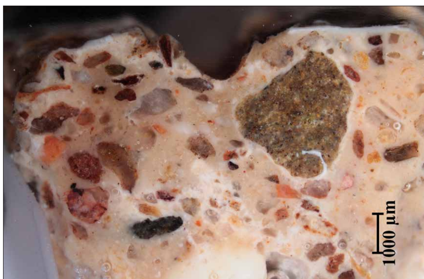
Obr. 223 Snímek příčného řezu vzorkem NV2 na optickém mikroskopu Nikon Eclipse LV100, při zvětšení na mikroskopu 20x. V horní části prohlubně rytí.
