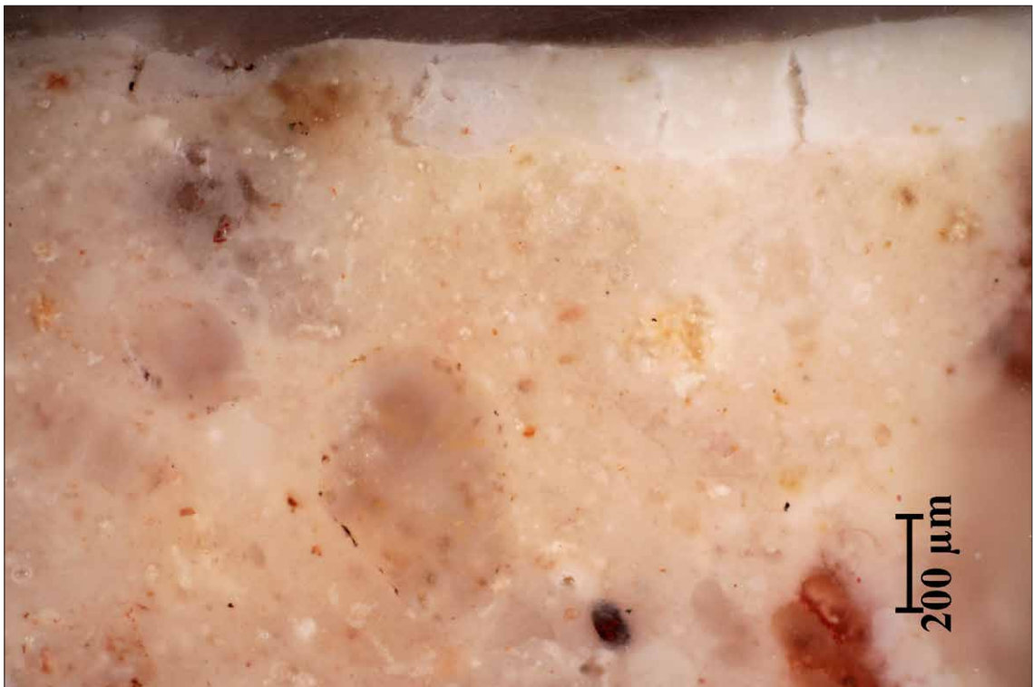
Obr. 214 Snímek příčného řezu vzorkem NV1 na optickém mikroskopu Nikon Eclipse LV100, při zvětšení na mikroskopu 100x. Intonaco bianco je nanášeno viditelně jako nátěr ve více vrstvách.
