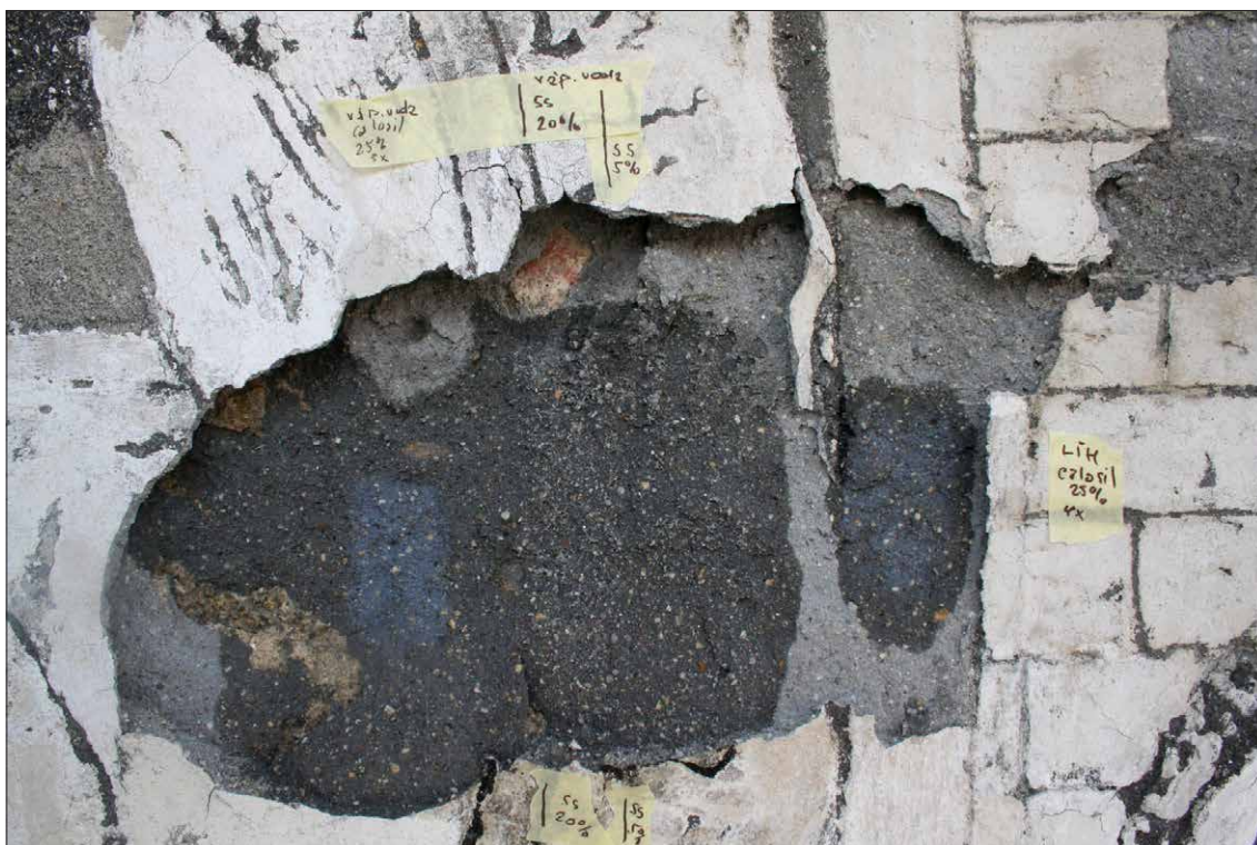
Obr. 64 Zkoušky typu konsolidačního prostředku - Sebosil S 20%, CaloSil E 50.
