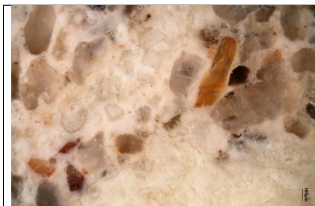
Nábrus, mikrofoto v bílém odraženém světle, nábrus, fotografováno při zvětšení 50x
