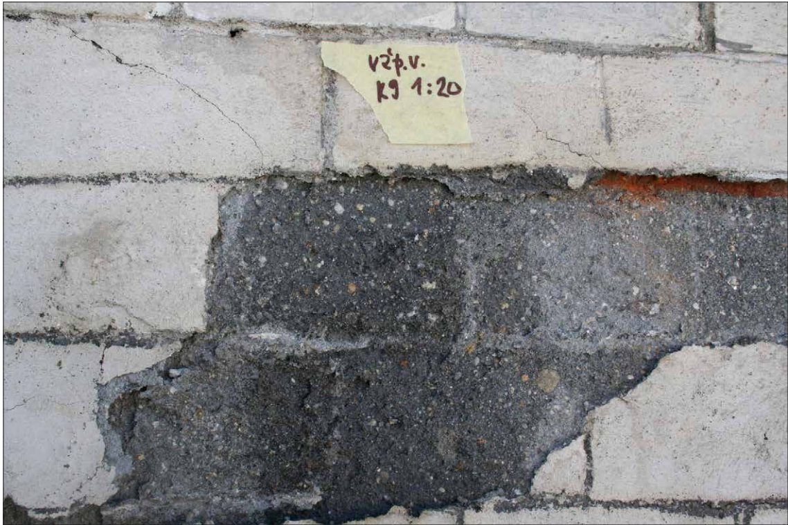
Obr. 65 Zkoušky typu konsolidačního prostředku - Primal K9.
