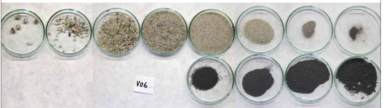
Vzorek VO6 (1991) rozdělený síťovou analýzou. Objemový poměr plniva je cca 1 písku : 3 strusky.
