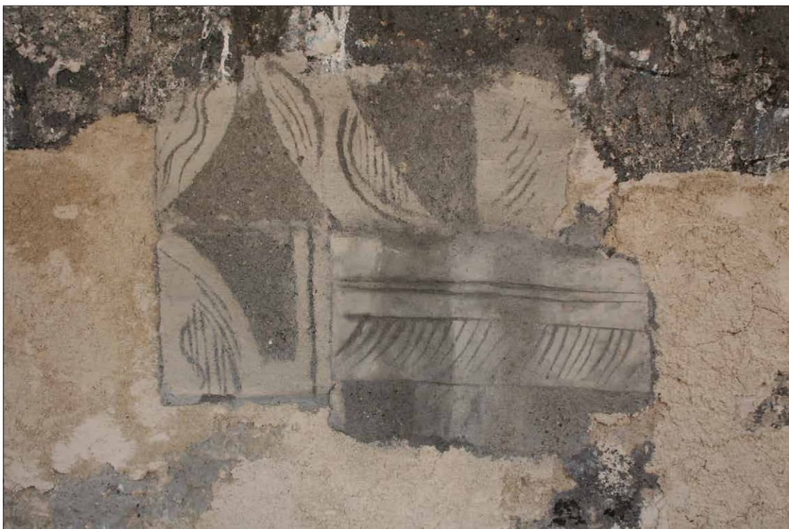
Obr. 68 Zkoušky tmelů. Jádrová omítka pískové barevnosti.
