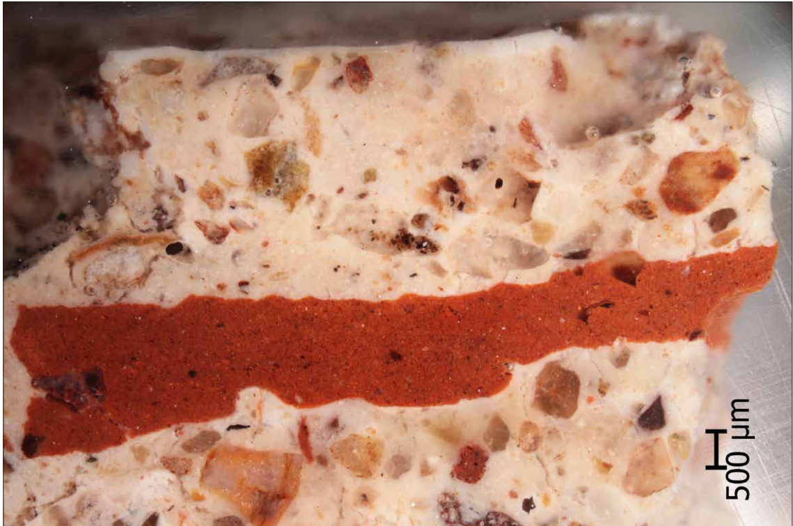
Obr. 213 Snímek příčného řezu vzorkem NV1 na optickém mikroskopu Nikon Eclipse LV100, při zvětšení na mikroskopu 20x. Vzorek je tvořen jedinou vrstvou omítky intonaca a nátěrem bianca. Červená plocha je kousek terakoty.
