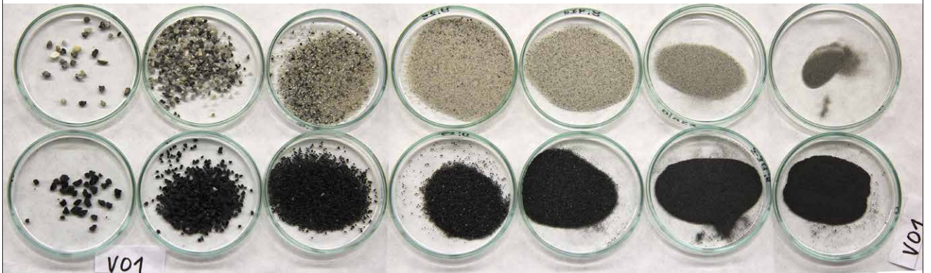
Vzorek VO1 (1965) rozdělený síťovou analýzou. Objemový poměr plniva je cca 1 písku : 1 uhlí.
