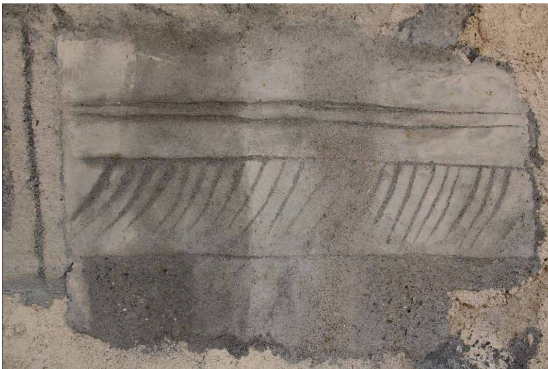
Obr. 69 Zkoušky tmelů. Intonaco. Finální vybraná receptura: 4 díly hašeného vápna + 5 díly dřevěné uhlí (0-2 mm) + 1 díl dřevěné uhlí (0,5-2mm) + 6 díl písek (0-2 mm) + 1/20 dílu cihelné drti (0-2 mm) + 1/20 dílu drceného ztvrdlého vápna (0-4 mm)
