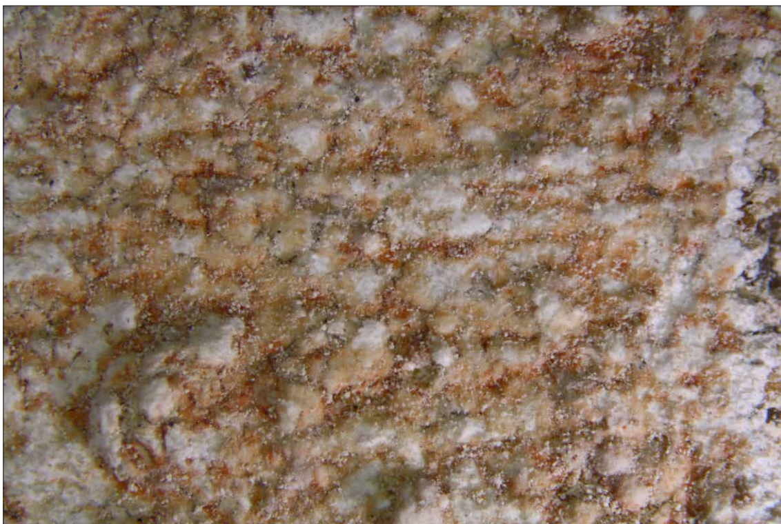
Obr. 264 Detail povrchu fragmentu renesančních sgrafit bočním nasvícením pod stereomikroskopem na vzorku SLVO1. Dobře patrné jsou stopy po štětci. Červená lazura je druhotného původu.
