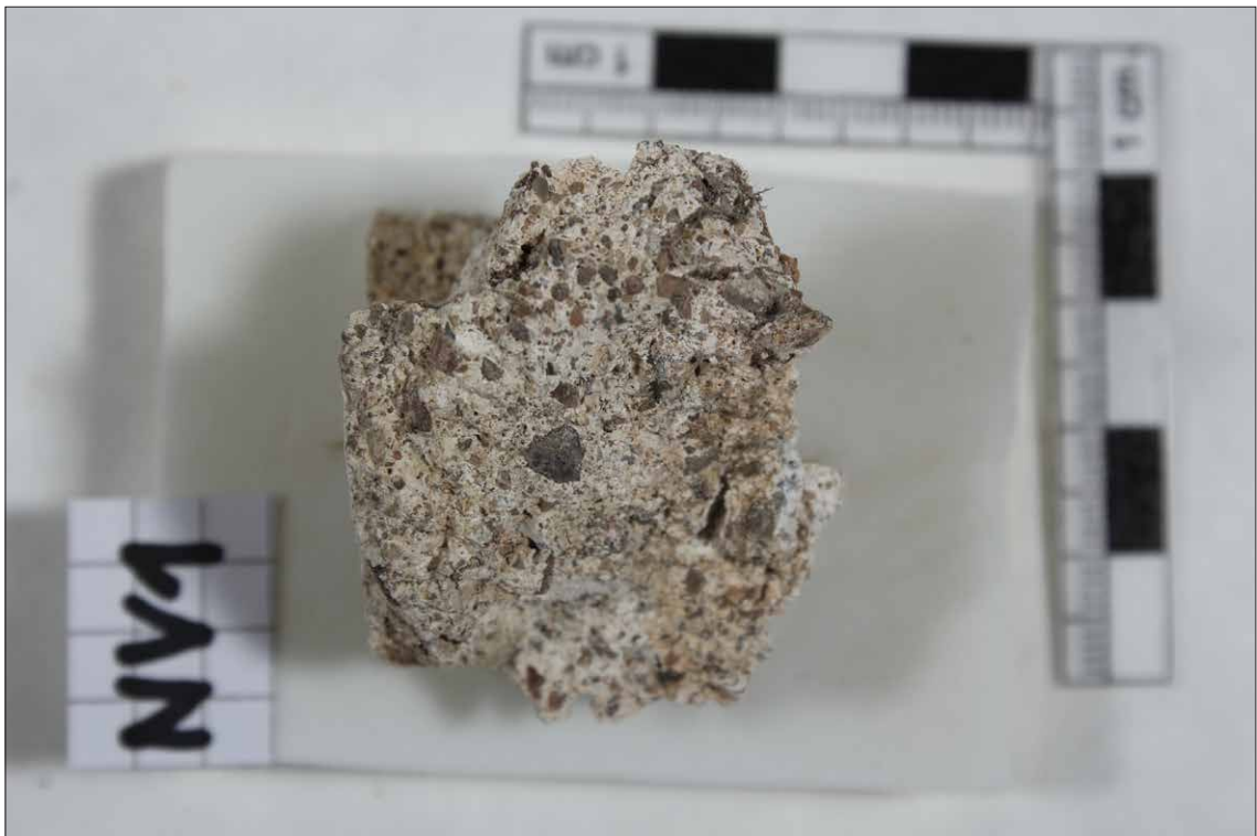
Obr. 212 Vzorek renesanční sgrafitové omítky NV1 odebraný z půdy Piccolominsko Kuronského traktu. Makrofoto vzorku, boční pohled (vlevo ostrá rovná plocha povrchu).
