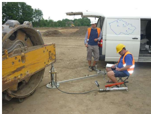
Obr. 67 – Statická zatěžovací zkouška
