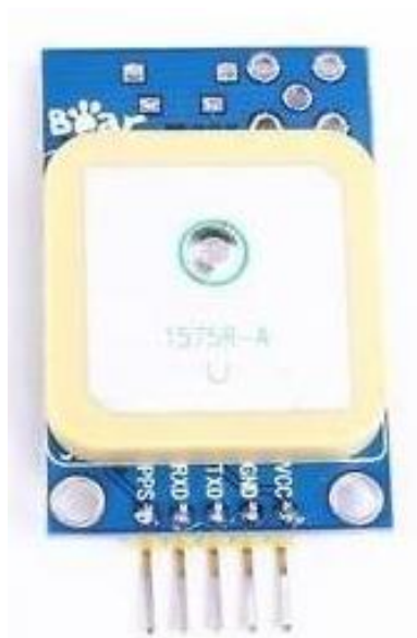
Obrázek 5.2 – GPS modul NEO-7M (ECLIPSEERA MODULES: GPS modul NEO-7M, 2017)
