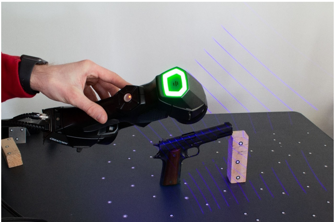
Obrázek 15: Indikace správné vzdálenosti laserového skeneru 16
