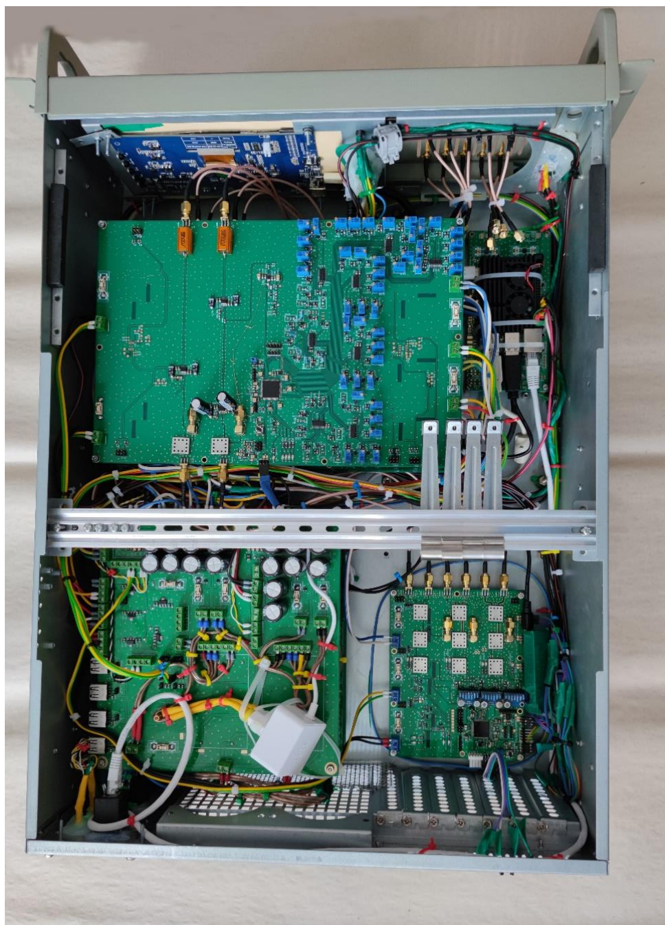
Obrázek 4.42 – Ukázka dokončeného generátoru definovaných signálu, bez krytu.
