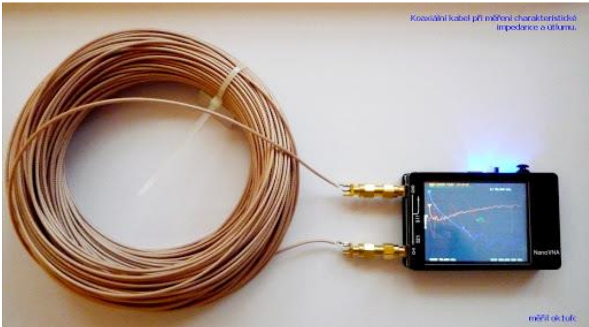
Obrázek 1.25 – Ukázka měření S-parametru pomocí Síťového analyzátoru, převzato ze [ (Šídlo, 2019)].
