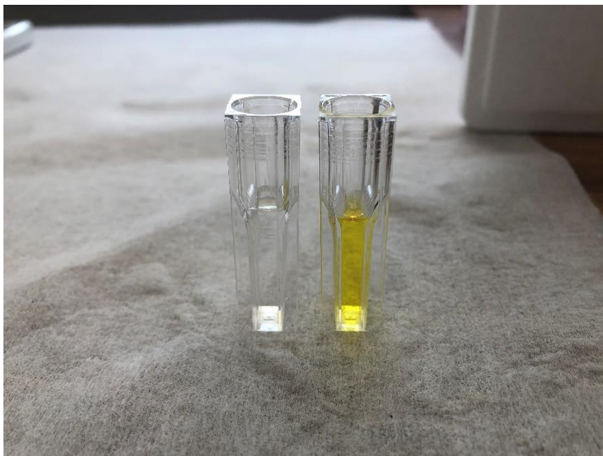
Obrázek č. 8: Srovnání blanku (vlevo) se směsí enzym + substrát + DTNB + PBS (vpravo)
