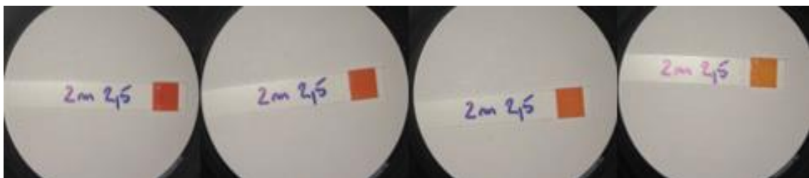
Obrázek č. 7: Barevný vývoj reakce enzym + substrát v závislosti na čase (0 s, 90 s, 10 min a 30 min) na pH papírcích MACHEREY-NAGEL
