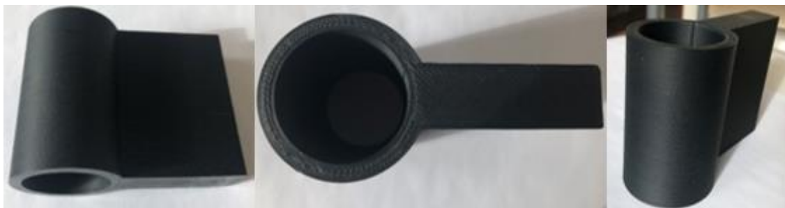
Obrázek č. 4: Stínítko používané proti vlivům okolního světla
