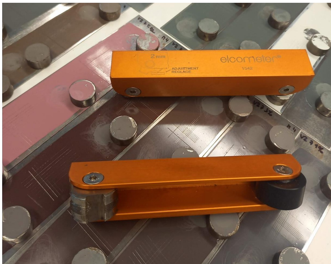
Obrázek 15: Nože na cross cut test se zkušebními vzorky
