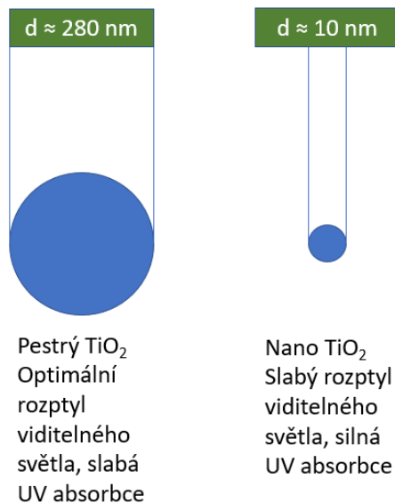
Obrázek 8: Porovnání běžných částic \text{TiO}_2 s nanočásticemi [45]
