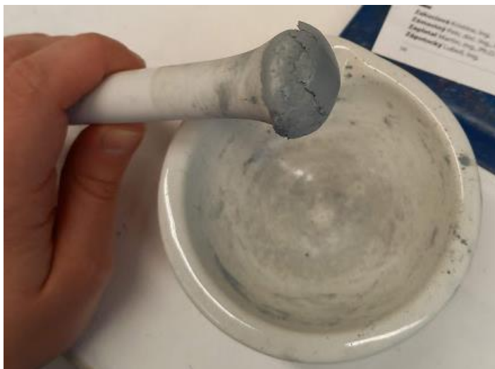
Obrázek 13: Konec nabalování pigmentu na tlouček. Všechny částice pigmentu jsou nasyceny olejem. V této fázi se určí obsah spotřebovaného oleje
