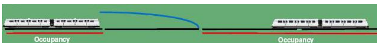
Obrázek 6 Jízda s pevným obsazením kolejových obvodů
