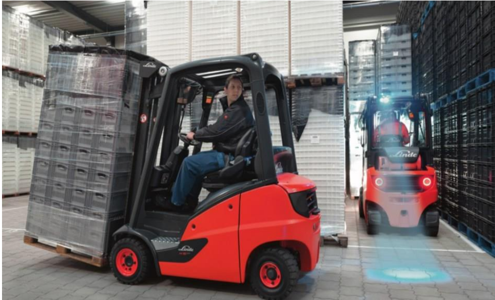
Obrázek 10 - Blue spot varující ostatní řidiče při pohybu vzad
