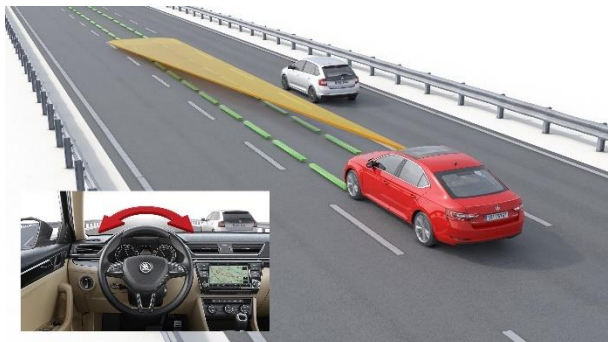
Obrázek 17 - Autonomní ř. (stupeň 1.) Lane assist, Adapt tempomat
