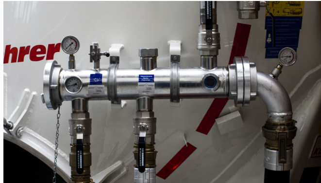
Obrázek 4: Rozdělovač tlakového vzduchu sklopného návěsu od výrobce Kässbohrer [9]
