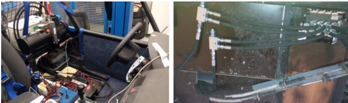
Obrázek 26: Umístění hydraulického agregátu a rozvaděče propojeného s dvojicí hydraulických zámek pomocí hydraulických hadic 3/4'' [23]
