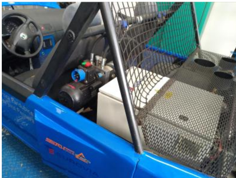
Obrázek 25: Umístění hydraulického agregátu za sedadlem řidiče [Autor]
