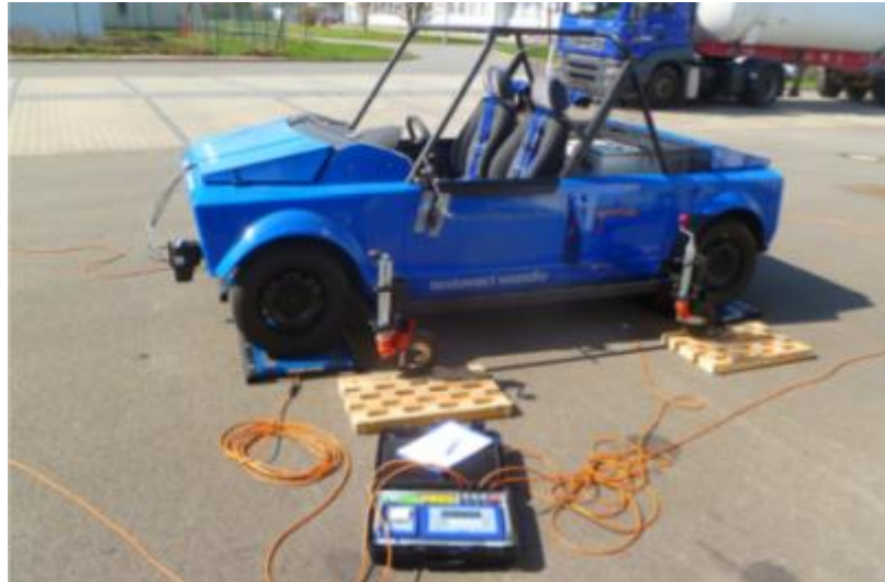
Obrázek 31: Experimentální vozidlo s mechanicky ovládanými přídavnými koly [23]
