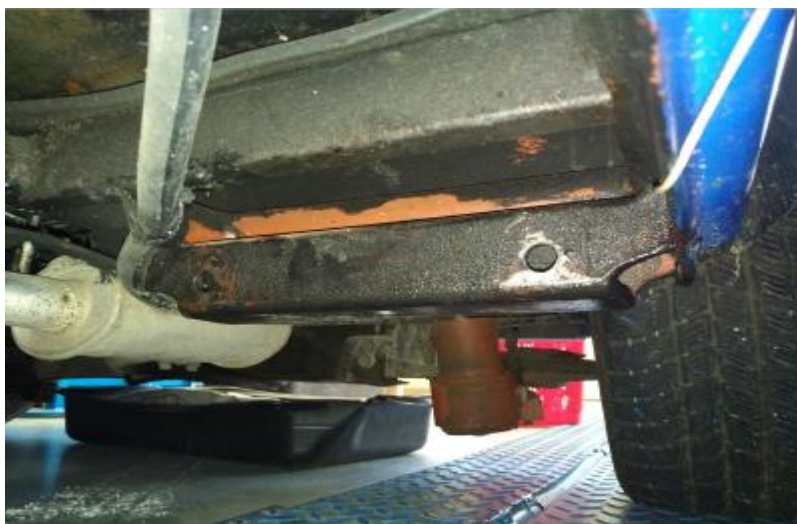
Obrázek 22: Přichytné místo pro uchycení přídatného rámu [Autor]
