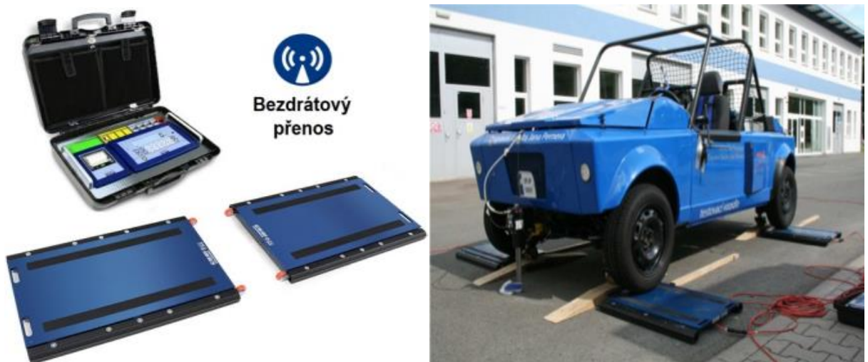
Obrázek 27: Nájezdová váha Dini Argeo Dfwkr, vážení experimentálního vozidla [23]
