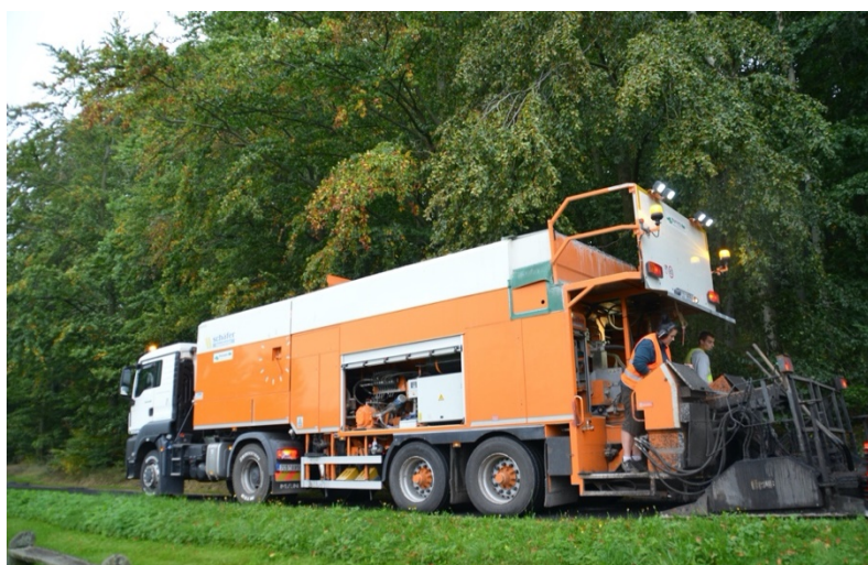
obrázek č. 15 – souprava pro pokládku mikrokoberce společnosti Vialit Soběslav – tahač MAN s kladecím mixem Schäfer Technic SMS 10 000 [21]
