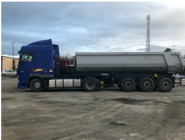
obrázek č. 18 – souprava pro dopravu kameniva, tahač s hliníkovou vanou a plachtou [21]
