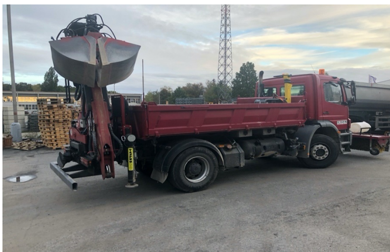
obrázek č. 16 – nákladní automobil s hydraulickou rukou pro nakládku kameniva (vzadu) a mechanickým zametačem (vpředu) [21]
