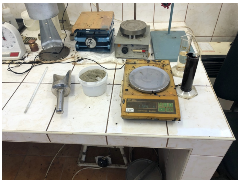
obrázek č. 29 – vybavení laboratoře – laboratorní váha, laboratorní stopky, skleněné odměrné válce s emulzí a vodou, plastový kelímek s cementem, keramická lžička na dávkování a laboratorní teploměr
