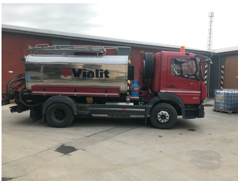
obrázek č. 17 – distributor pro aplikaci spojovacích postřiků, cisterna o objemu 5000 l, podvozek Mercedes Benz Antos, vzadu roztahovací lišta do 4 m [21]
