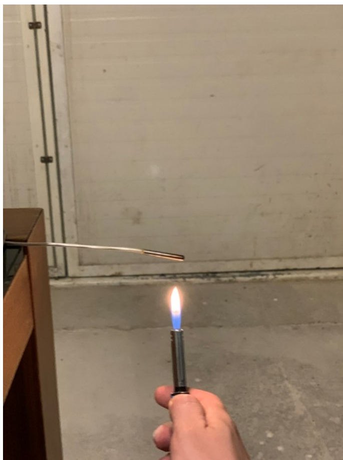
Obr. 3.8 – Způsob ohřevu čidla Pt1000
