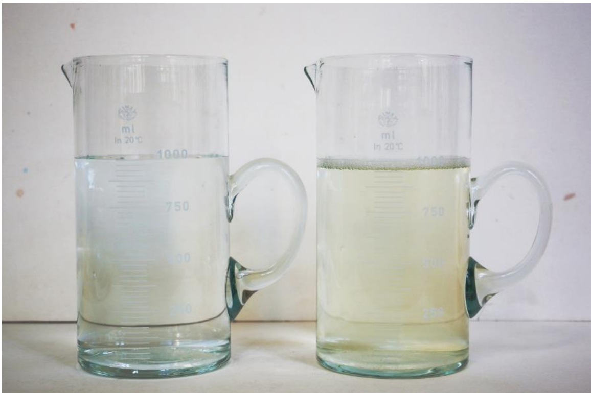
Obr. 20 Rozdíl čisté vody (vlevo) a vody z lázně po mokrém čištění (vpravo)
