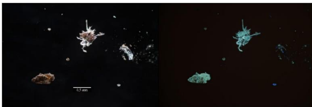
Obr. 7, 8 Optická mikroskopie, vzorek z vrchní strany, bílé světlo, UV fluorescence.
