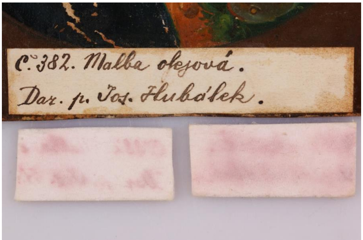
Obr. 13 Důkaz přítomnosti volných železnatých iontů v záznamovém prostředku
