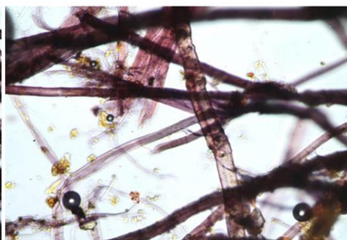
Obrázek 4 Vlákнинové složení vzorku KM_2, zvětšeno 50x, Herzbergova zkouška.
