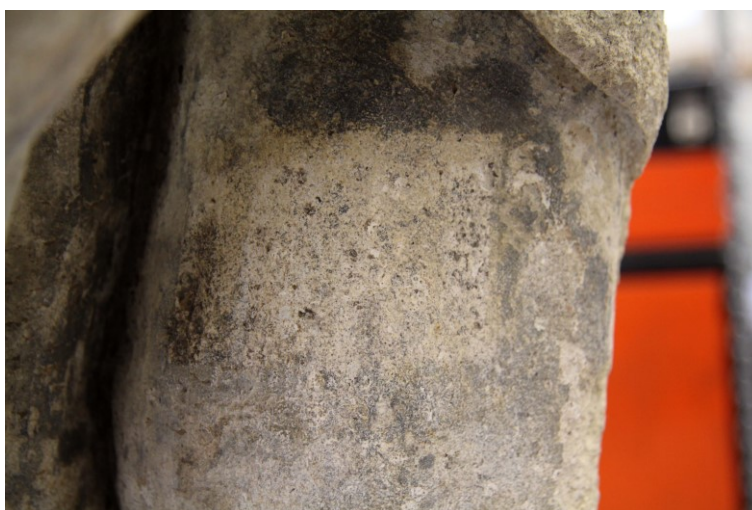
obr. 29 Průběh čištění lasere vlnová délka 1064 nm. při energii 175 mJ. kombinací s mikropískování bílým korundem 220 a tlaku 2 barů
