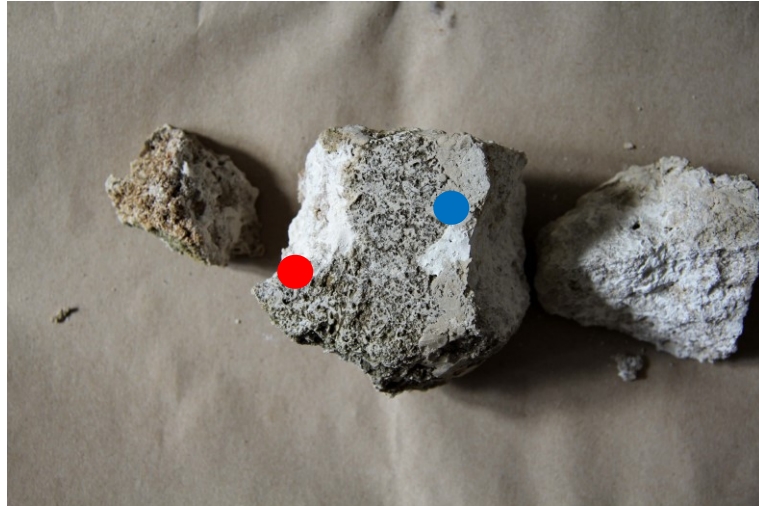
obr. 23 Zkouška injektážní směsi, červená Ledan TA1, modrá Vapo injekt
