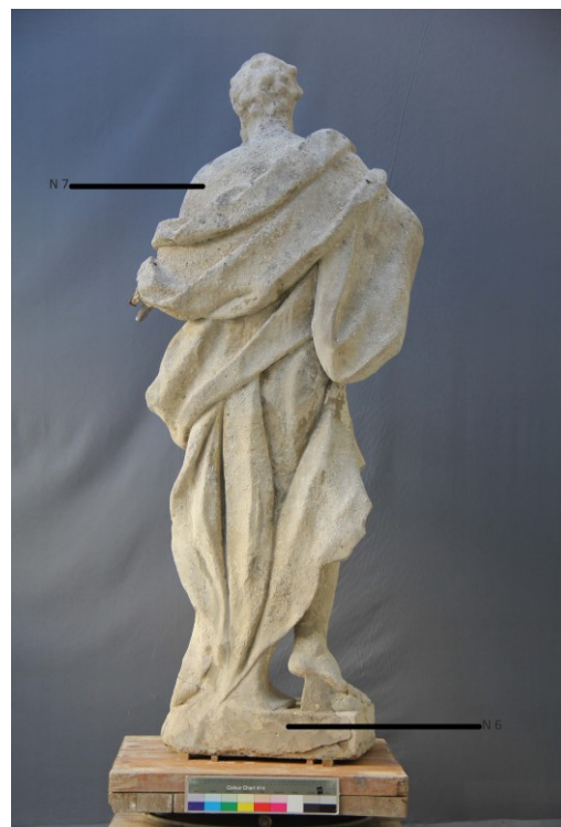
obr. 11 Místa měření nasákavosti, zadní pohled
