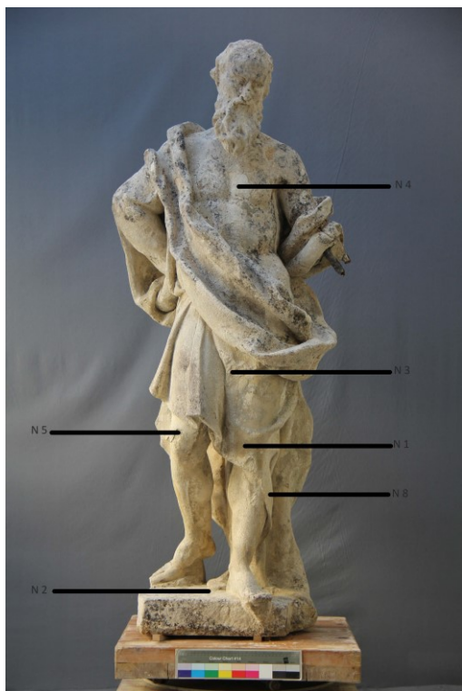
obr. 12 Místa měření nasákavosti, přední pohled
