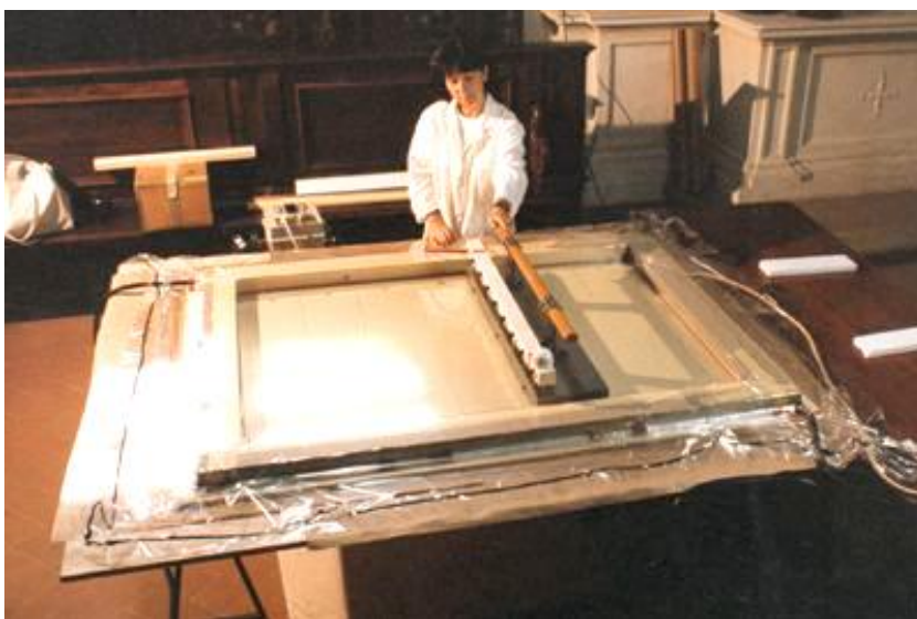
Obr. 2 Topné zařízení pro zahřívání plochy vakuové obálky
