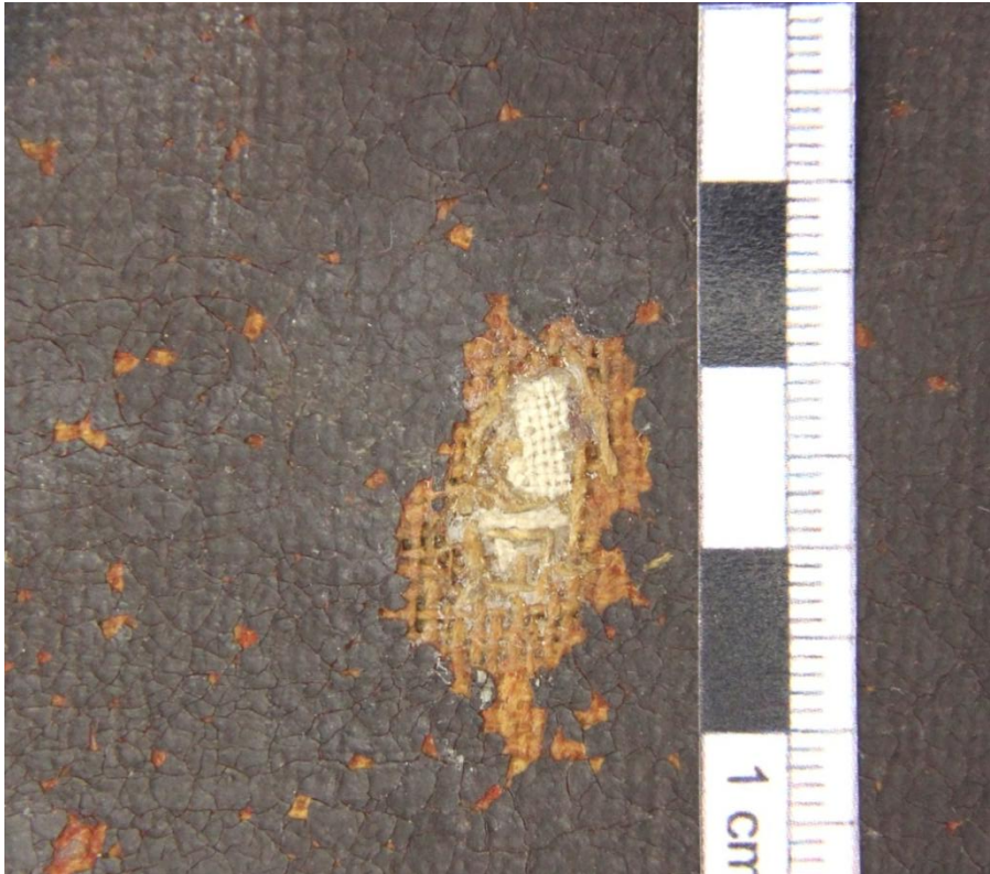
Obr.31 Průběh restaurování, líc, detail vysprávky vloženou záplatou ze lněného plátna a Lascaux Heat-Seal Adhesive 375.
