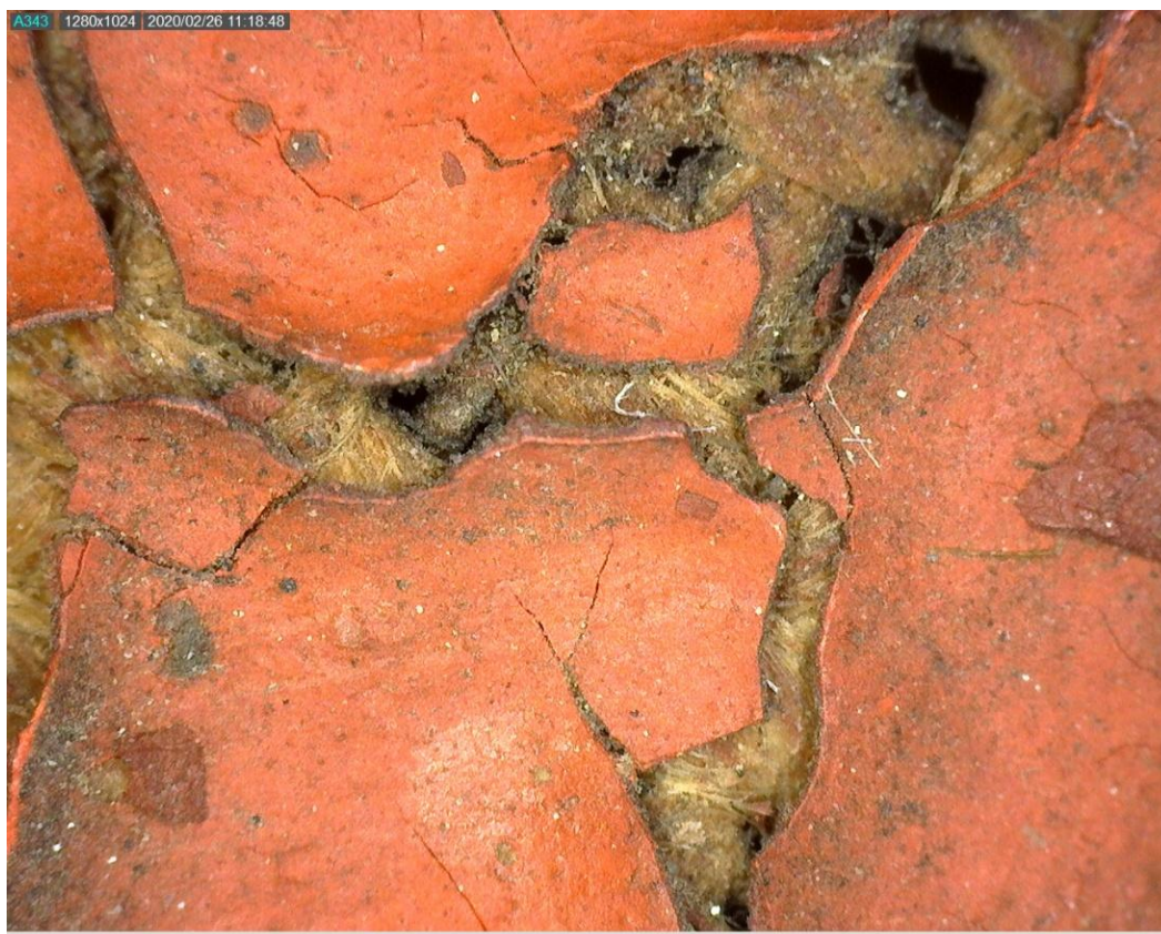
Obr. 13 Stav před restaurováním, líc, detail krakel v místě levého rukávu, viditelné světlo, USB mikroskop.
