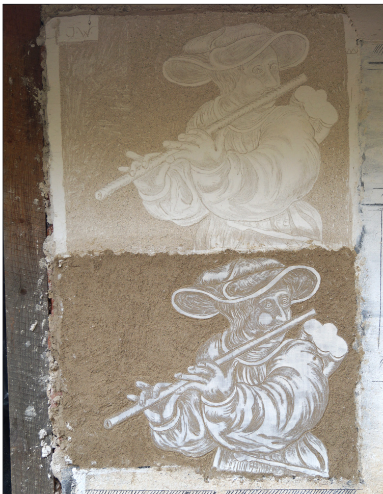
Obr. 152 Zkušební panel zacílený na časování jednotlivých kroků denního dílu a zkouška přenášení kompozice z pauzy, zkouška techniky prokletování (posloupnost A – D). Výjev píštěce byl proveden pro porovnání vizuálního efektu ve dvou variantách z komerčního písku (Černuc, horní výjev) a kopaného písku z duny v lese u Slavonic.
