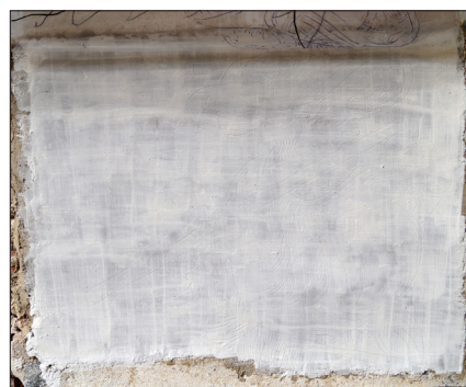
Obr. 152 Zkušební panel zacílený na časování jednotlivých kroků denního dílu a zkouška přenášení kompozice z pauzy, zkouška techniky prokletování (posloupnost A – D). Výjev píštěce byl proveden pro porovnání vizuálního efektu ve dvou variantách z komerčního písku (Černuc, horní výjev) a kopaného písku z duny v lese u Slavonic.
