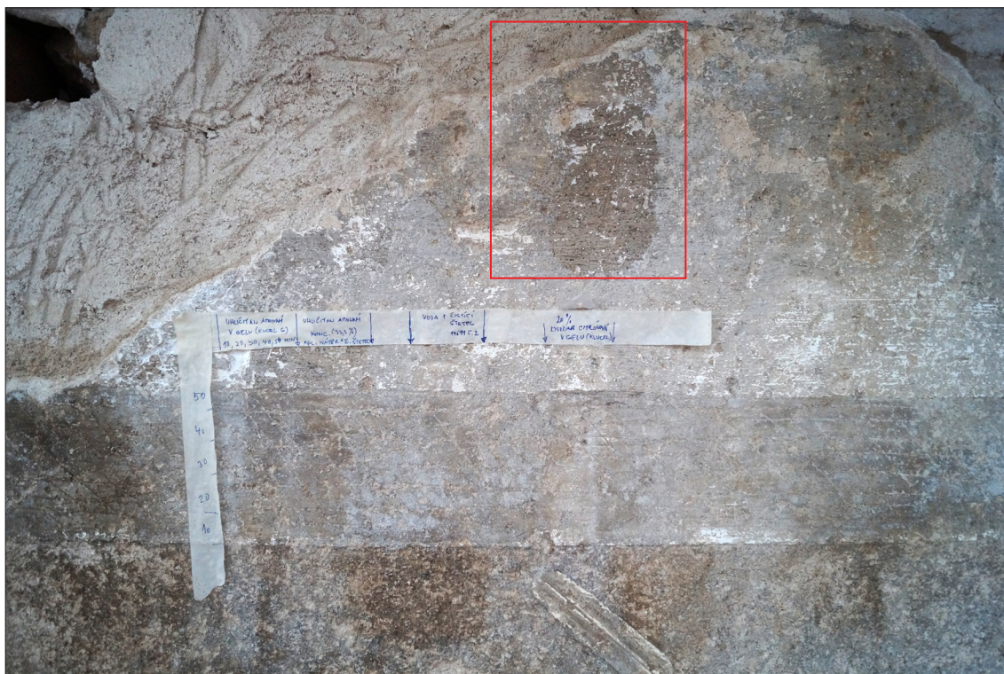
Obr. 127 Výsledky čistících obkladů pro čištění šedého zákalu. Nejúčinnější je dlouhodobý obklad kyselinou citrónovou v Arbocelu a Klucelu (ve směsi). Tato zkouška však byla vyhodnocena jako příliš riziková a zákal byl mírně eliminován opakovaným mytím vodou.
