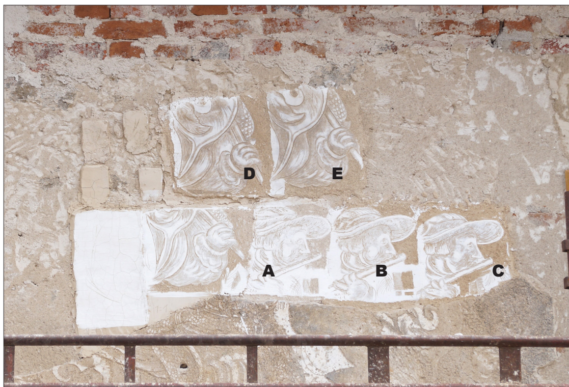
Obr. 155 Zkušební vzorky přímo na fasádě a klínky pro zjištění nosnosti omítky (viz též obr 99 –101) A komerční písek Tasovice, B směs kopaného písku v okolí Slavonic (z lesa) a Tasovic 1 : 1, C ze kopaného písku v okolí Slavonic; ve všech směsích stejný poměr pojiva - nedvědického hydrátu. D písek ze vzorku C smíchaný s pískem z jiného ložiska u Slavonic (nalezená duna ve staré pískovně).
