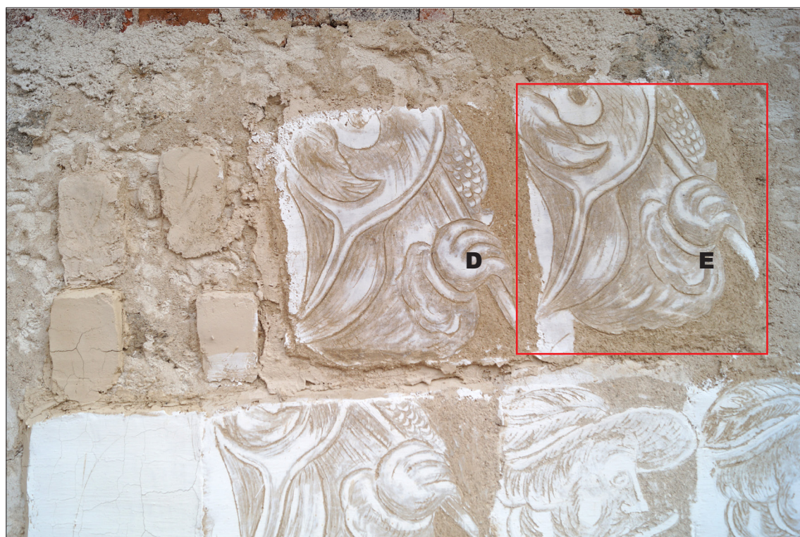
Obr. 156 Jako nejkompatibilnější byl vyhodnocen vzorek E z „nového“ ložiska ve staré slavonské pískovně u stálkovské silnice.
