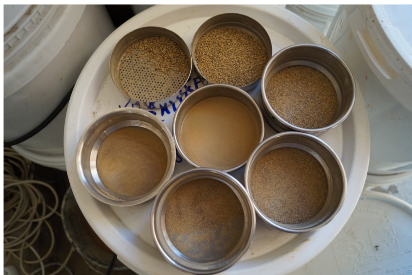
Obr. 97 Rozložení frakcí ve slavonickém písku, kompatibilní je s původními sgrafity i barevností.
