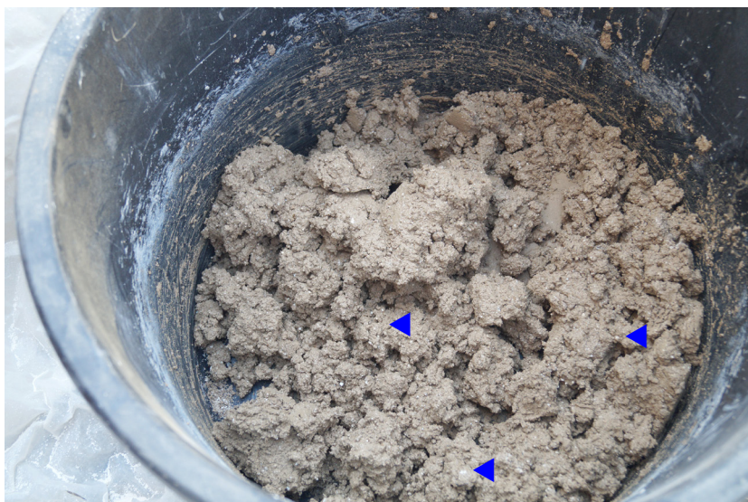
Obr. 98 Rozmíchané barevné intonaco s bílými „cucky“ pojivových částic.
