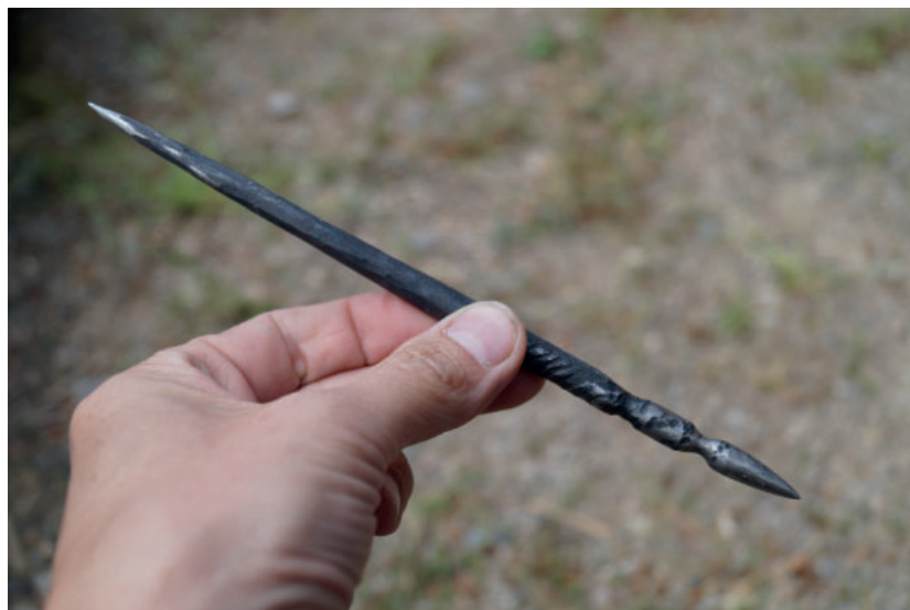
Obr. 20 Gràffico, neboli jehla, špičaté železo, nástroj vyrobený zakováním a zakalením železné tyčoviny. Tento nástroj tvoří trasologické stopy kompatibilní s dochovanými originály sgrafita.
