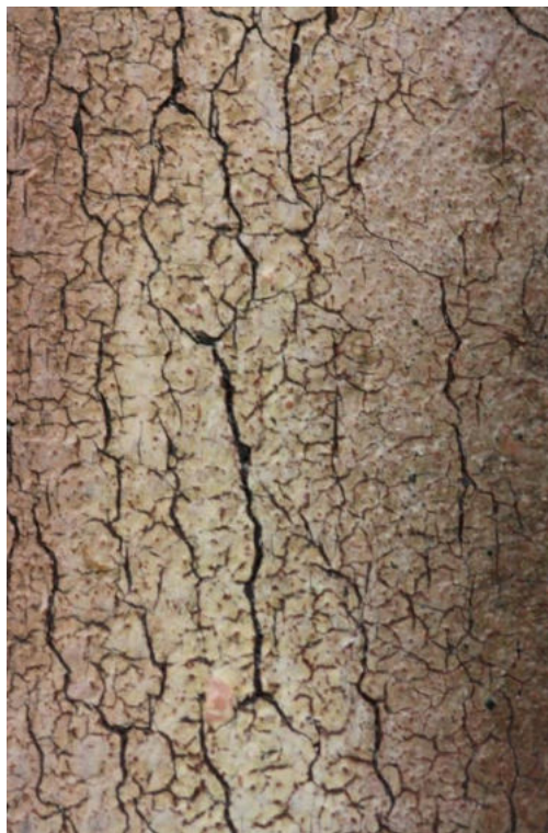
Obr. 32: Průběh restaurování, detail barevné vrstvy po čištění 1 % vodným roztokem citrátu, pohledová strana, zářivkové světlo.
