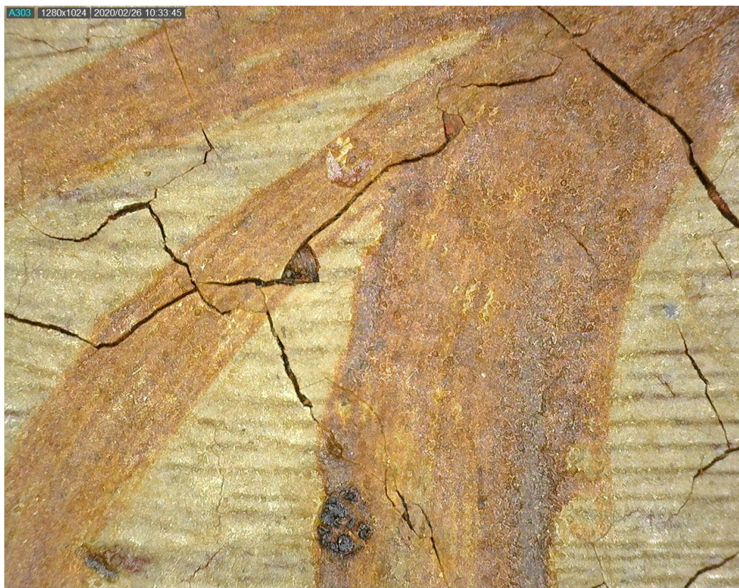
Obr. 1. 28 Snímek z USB mikroskopu, detail dekoru šatů, krakeláž barevné vrstvy, zvětšení 50×
