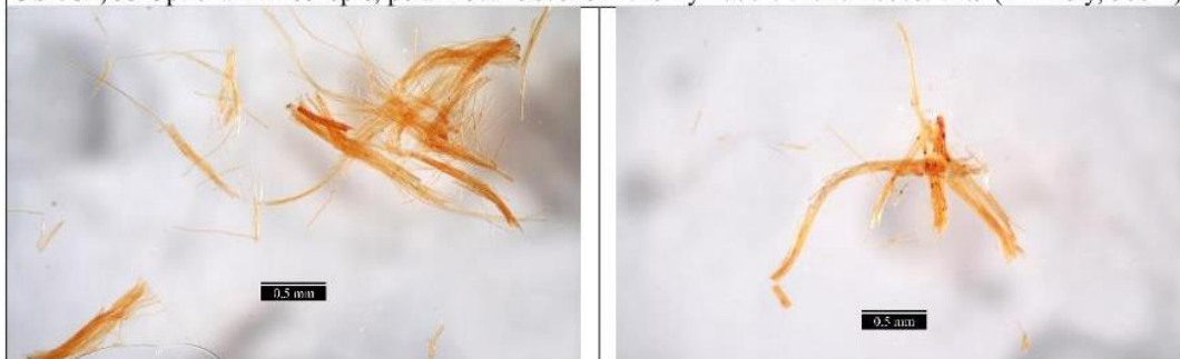
Obr. 34, 35 Optická mikroskopie, odražené světlo, floroglucin – vzorky 10004/Vz.4 a 10005/Vz.5 (50 ×).
